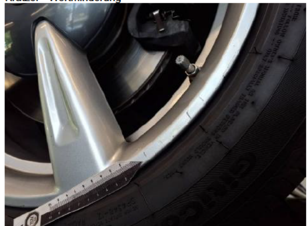
Beschädigung #3: Rad/Reifen: Leichtmetallfelge vorn rechts - Kratzer - Wertminderung
