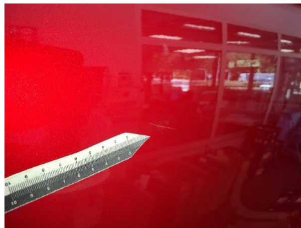
Beschädigung #6: Tür vorn links: Tür - Kratzer - lackieren
