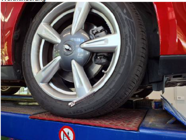
Beschädigung #3: Rad/Reifen: Leichtmetallfelge vorn rechts - Kratzer - Wertminderung
