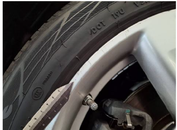
Beschädigung #2: Rad/Reifen: Leichtmetallfelge vorn links - Kratzer - Wertminderung
