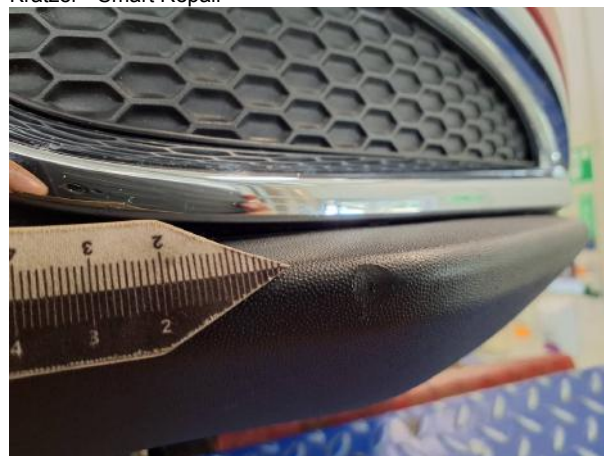
Beschädigung #5: Stossfänger vorn: Spoiler - Kratzer - erneuern
