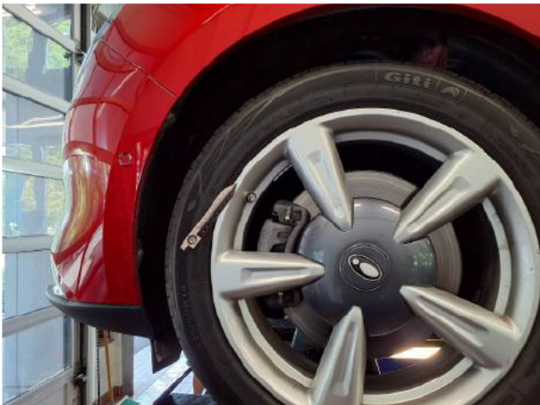
Beschädigung #2: Rad/Reifen: Leichtmetallfelge vorn links - Kratzer - Wertminderung
