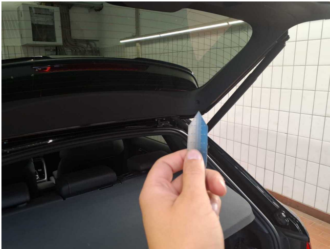
Damage 1: Trim / covers: Boot lid - interior trim (Befestigungsöse für Hutablage) - Missing - Replace
