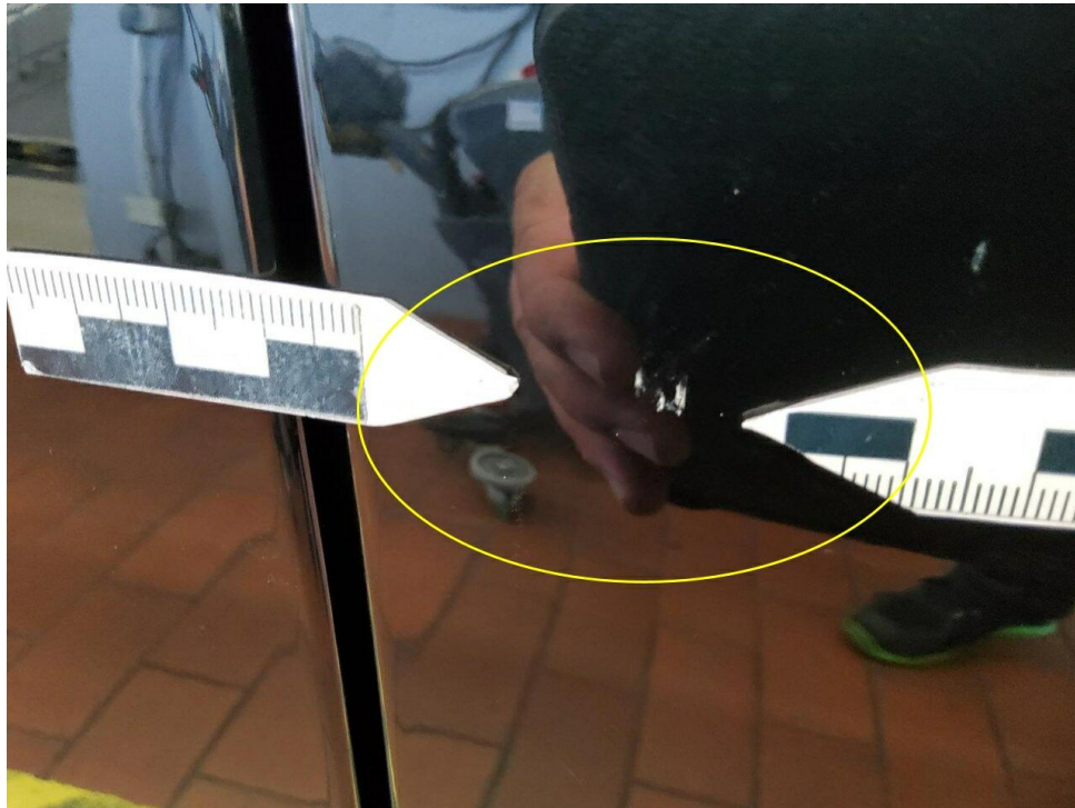
Bild 17 : Tür vorne rechts Lackierung, zerkratzt, smart repair
