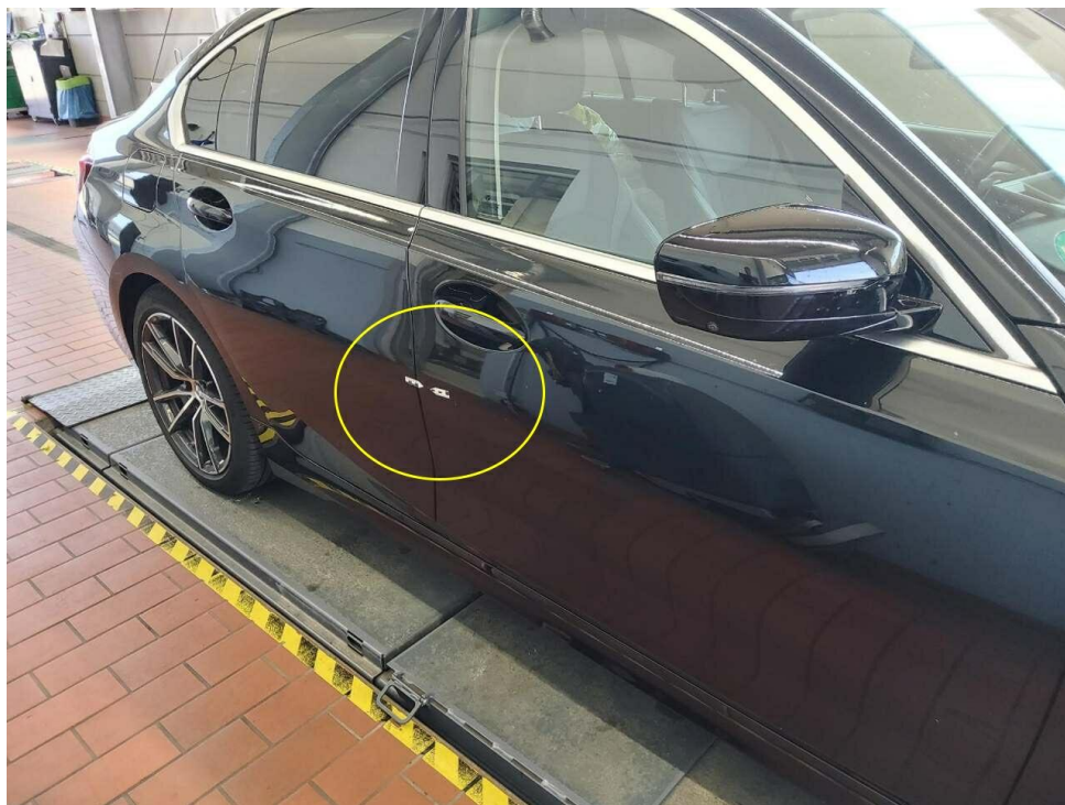
Bild 16 : Tür vorne rechts Lackierung, zerkratzt, smart repair
