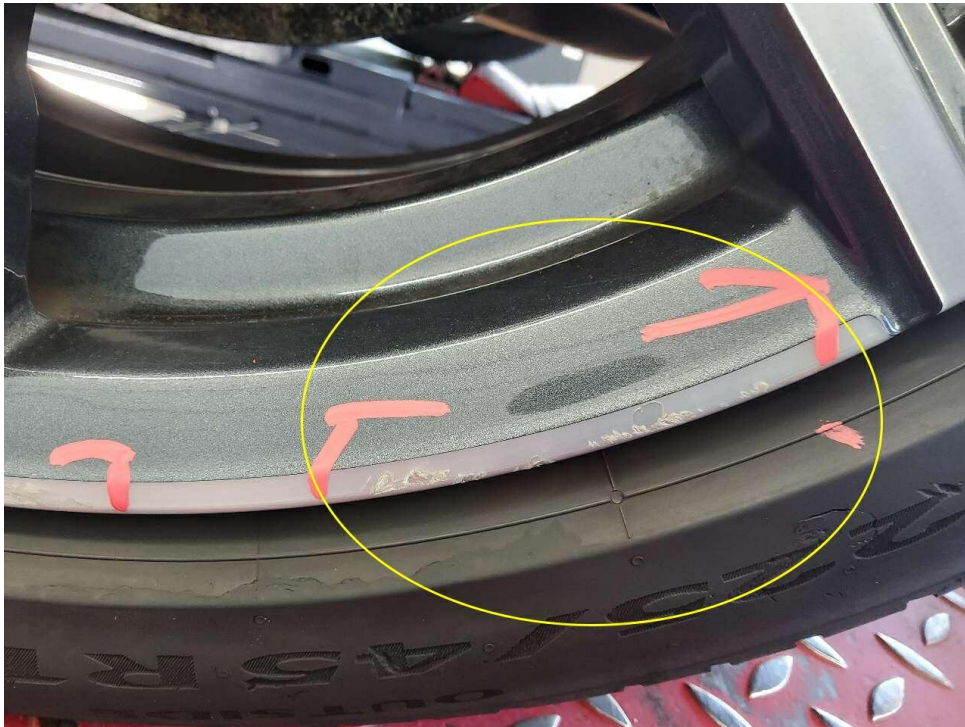
Bild 27 : Alufelge glanzgedreht, Sommerräder vorne rechts, verschrammt, mit Materialabtragung
