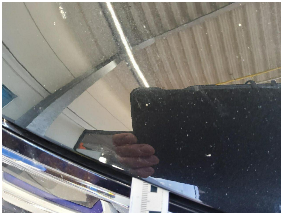
Bild 22 : Motorhaube Lackierung, viele Steinschläge, lackieren mit Lackaufbau
