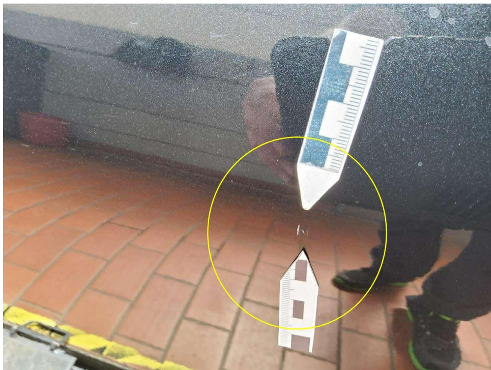
Bild 20 : Tür hinten links Lackierung, zerkratzt, smart repair
