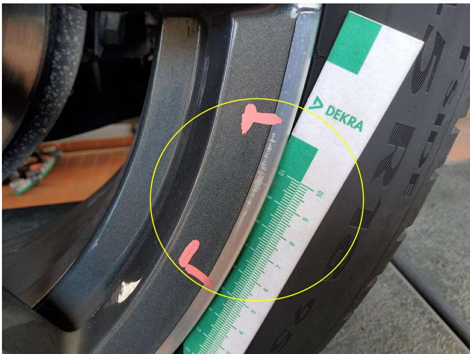
Bild 32 : Alufelge glanzgedreht, Sommerräder hinten links, verschrammt, mit Materialabtragung
