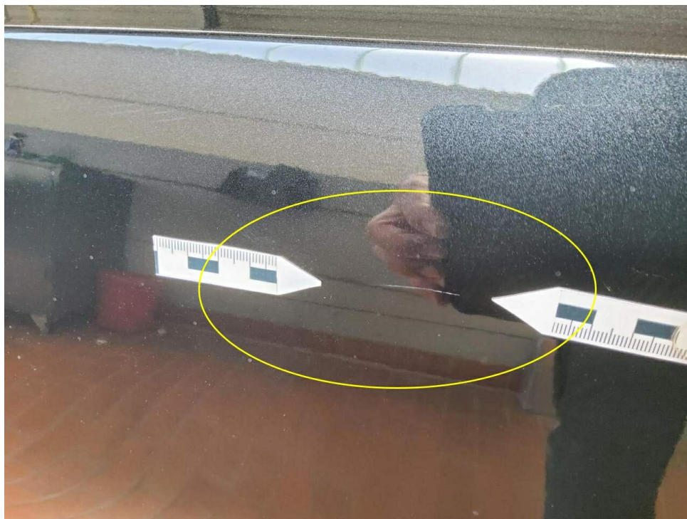
Bild 19 : Tür hinten links Lackierung, zerkratzt, smart repair
