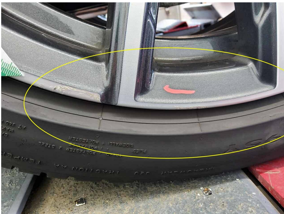
Bild 28 : Alufelge glanzgedreht, Sommerräder vorne rechts, verschrammt, mit Materialabtragung Tür vorne rechts Lackierung, zerkratzt, smart repair
