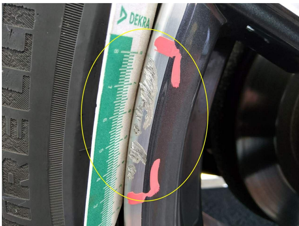
Bild 30 : Alufelge glanzgedreht, Sommerräder hinten rechts, verschrammt mit Materialabtragung
