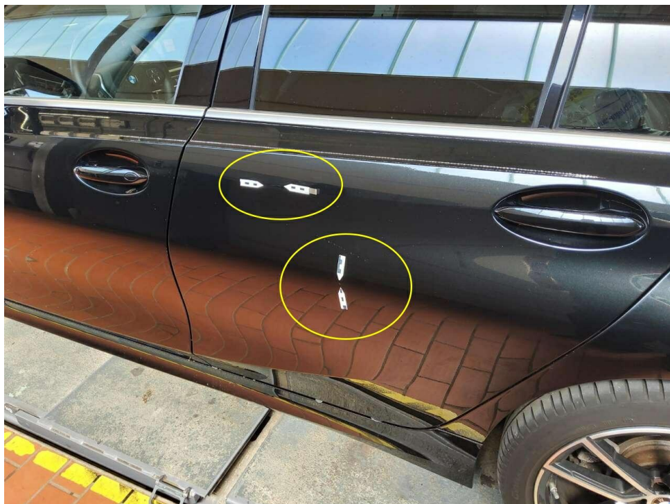
Bild 18 : Tür hinten links Lackierung, zerkratzt, smart repair
