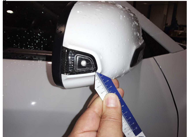
Beschädigung #2: Blinkleuchte: Spiegel rechts - gebrochen / gerissen - erneuern
