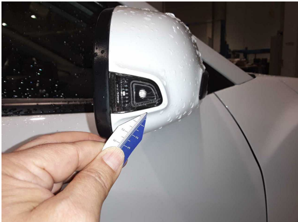
Beschädigung #2: Blinkleuchte: Spiegel rechts - gebrochen / gerissen - erneuern
