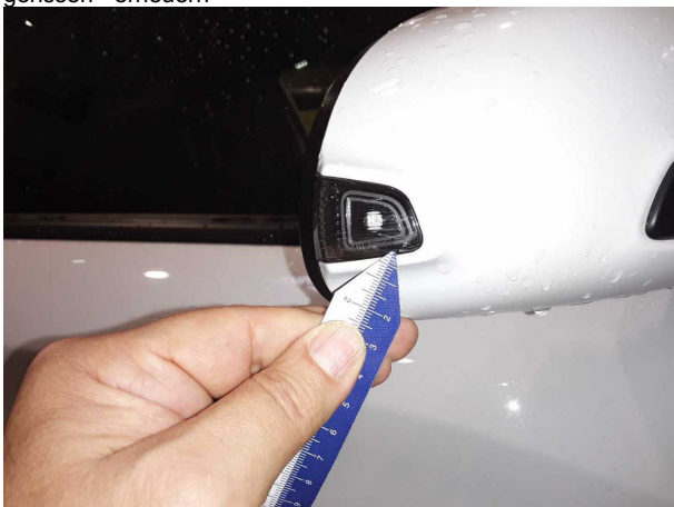
Beschädigung #2: Blinkleuchte: Spiegel rechts - gebrochen / gerissen - erneuern
