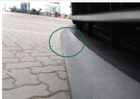
Stoßfänger unterhalb / Vorne / Delle
