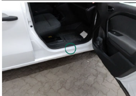
Türeinstieg / Vorne Rechts / Delle
