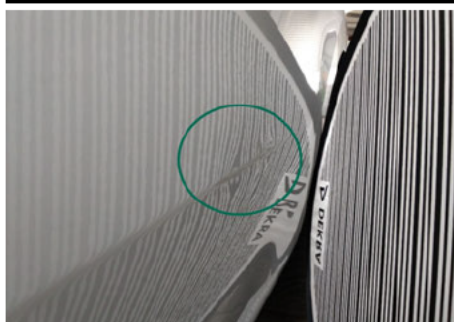
Seitenwand / Unten Links / Delle
