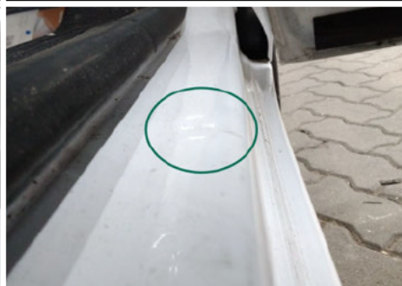
Türeinstieg / Vorne Rechts / Delle
