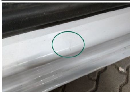
Türeinstieg / Vorne Rechts / Delle
