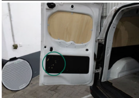
Innenverkleidung Laderaum / Unten Hinten Links / Gebrochen
