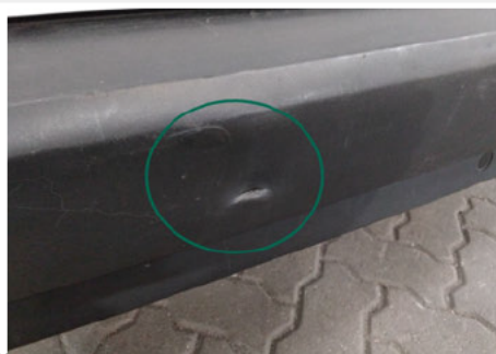
Stoßfänger / Hinten / Gebrochen
