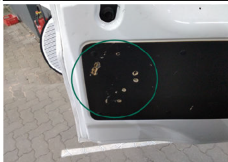
Innenverkleidung Laderaum / Unten Hinten Links / Gebrochen
