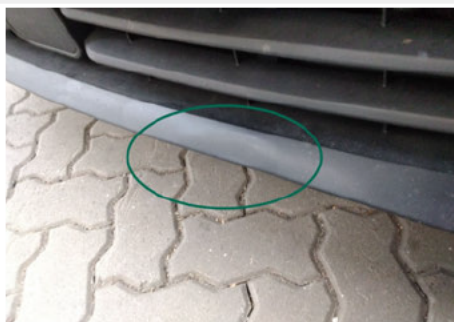
Stoßfänger unterhalb / Vorne / Delle
