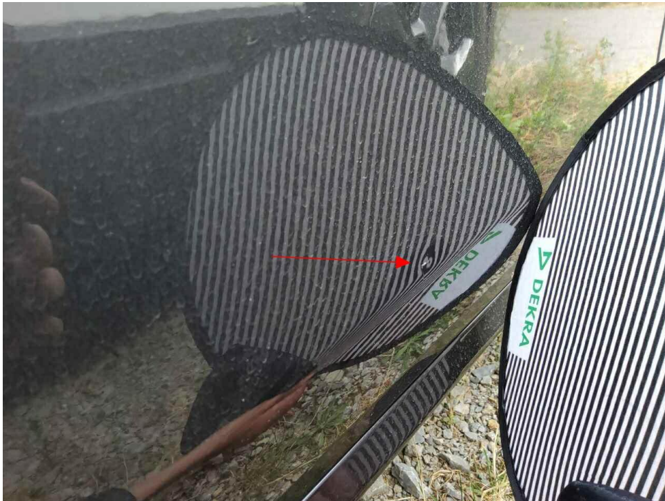
Bild 15 : Tür vorne rechts Delle und Kratzer
