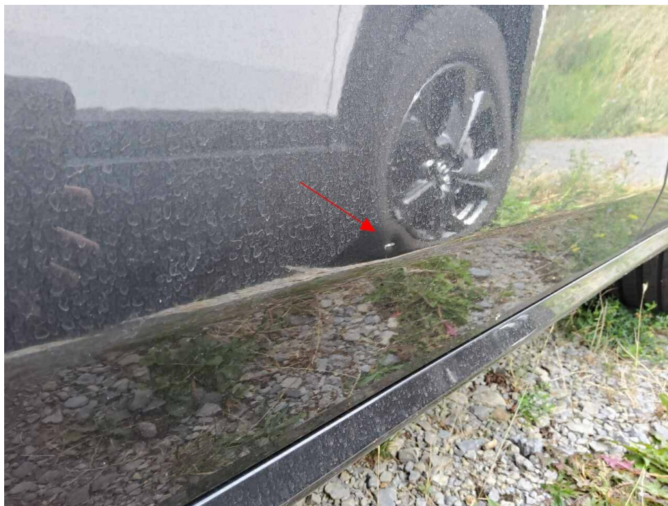
Bild 14 : Tür vorne rechts Delle und Kratzer
