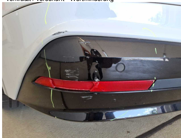
Beschädigung #8: Stossfänger hinten: Spoiler - verkratzt / verschürft - erneuern
