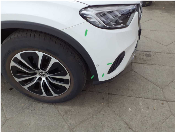
Beschädigung #2: Kotflügel rechts: Radhausverbreiterung - Kratzer - Smart Repair
