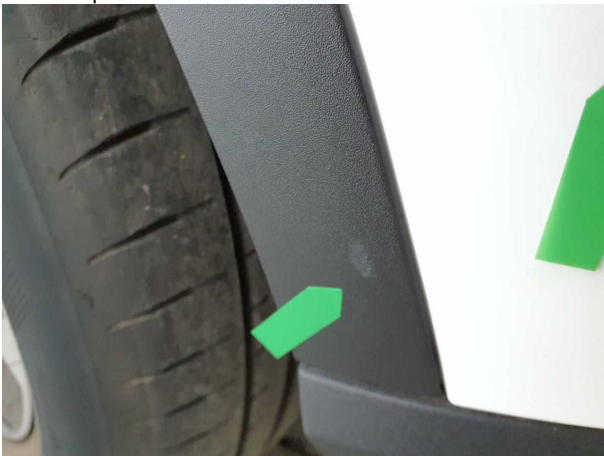
Beschädigung #2: Kotflügel rechts: Radhausverbreiterung - Kratzer - Smart Repair
