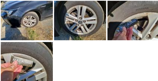
Alloy rim RL, Scratch(es), Repair/replace (lump sum)
