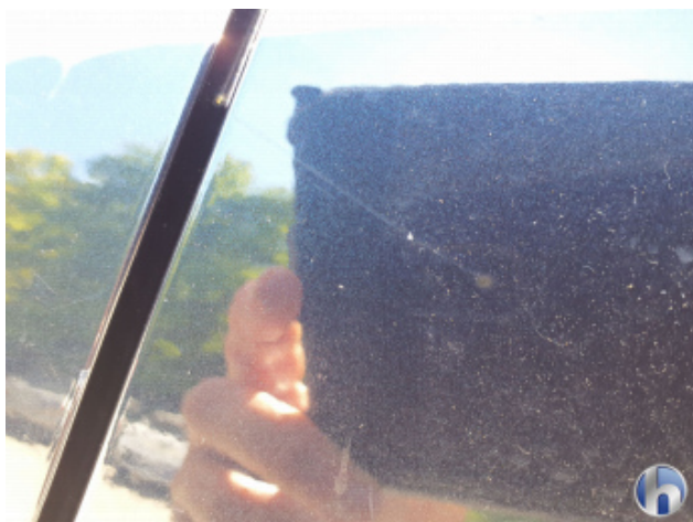
3. Seitenwand - Hinten - Links Kratzer - Lackieren
