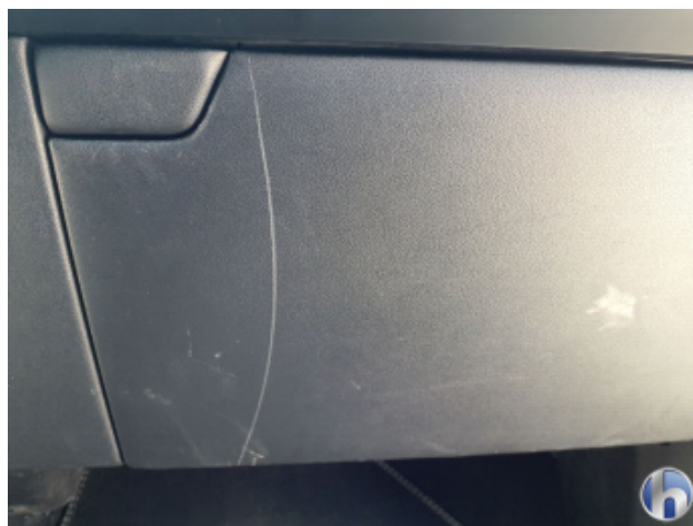
5. Handschuhfach Beschädigt - Erneuern
