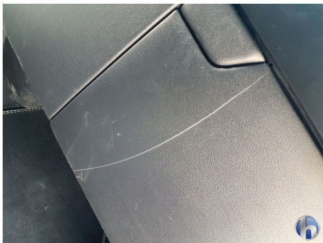
5. Handschuhfach Beschädigt - Erneuern
