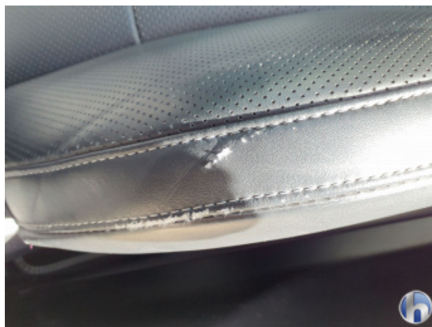
6. Sitz Innenraum links vorne Beschädigt - Erneuern
