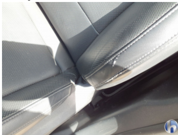
6. Sitz Innenraum links vorne Beschädigt - Erneuern
