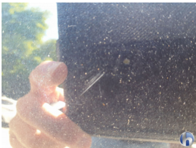
3. Seitenwand - Hinten - Links Kratzer - Lackieren
