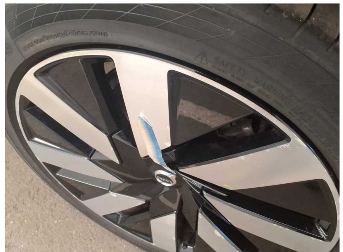
Damage 6: Wheel / tyres: Alloy rim - rear right side (Material Veränderung an glanzgedrehten stellen) - Corrosion - Loss in value
