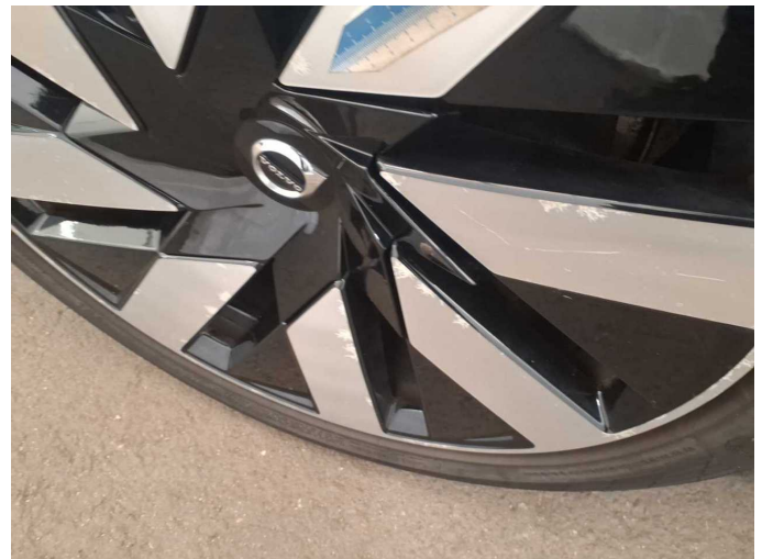
Damage 5: Wheel / tyres: Alloy rim - front left side (Material Veränderung an glanzgedrehten stellen) - Corrosion - Loss in value
