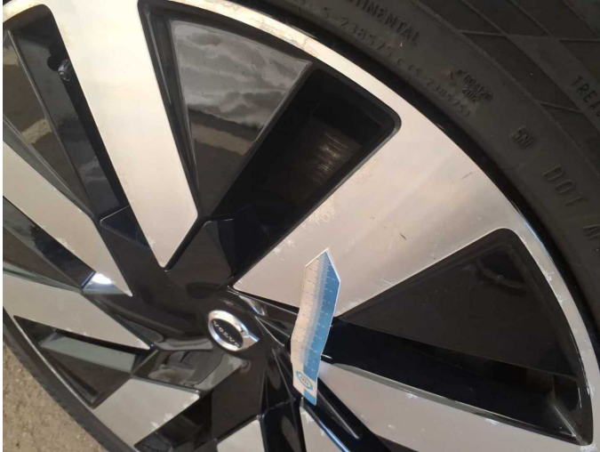
Damage 4: Wheel / tyres: Alloy rim - front right side (Material Veränderung an glanzgedrehten stellen) - Corrosion - Loss in value
