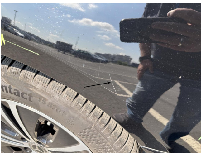
Fondseite links - zerkratzt - Lackieren
