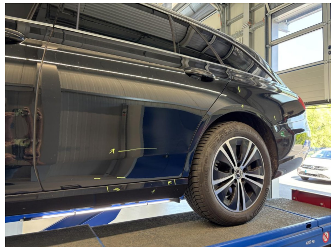
Tür hinten links - zerkratzt - Lackieren
