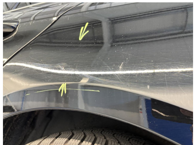
Fondseite links - zerkratzt - Lackieren
