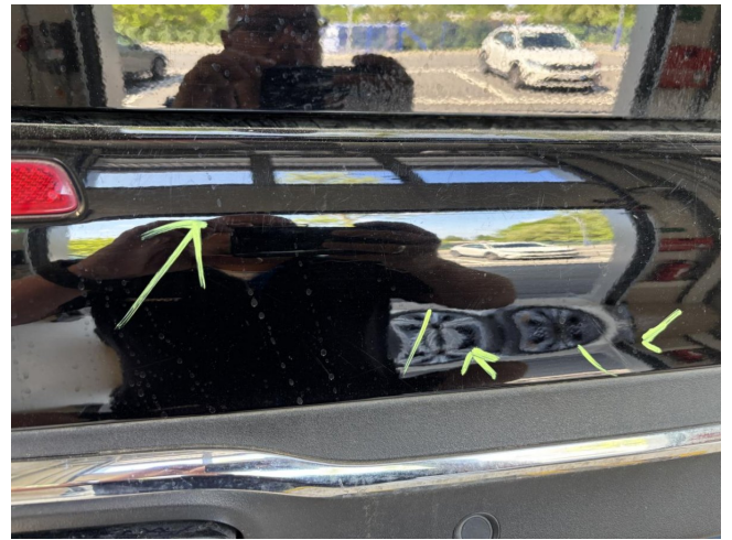
Stoßfänger hinten - zerkratzt - Lackieren
