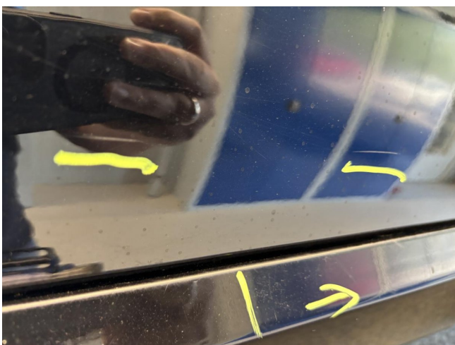
Tür hinten links - zerkratzt - Lackieren
