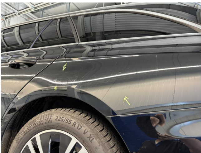
Fondseite links - zerkratzt - Lackieren
