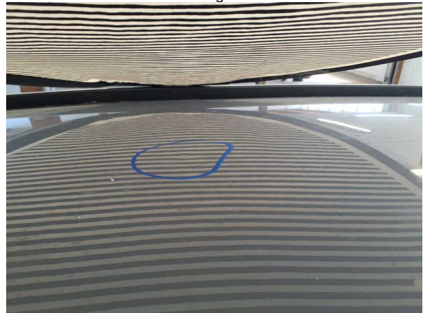
Beschädigung #3: Fahrzeugdach: Dach - Delle(n) - sanft instandsetzen
