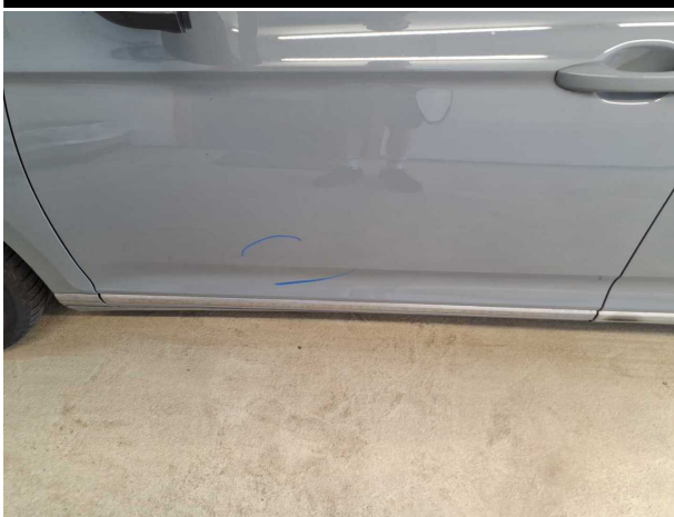
Beschädigung #9: Tür vorn links: Tür - verkratzt / verschürft - instandsetzen und lackieren
