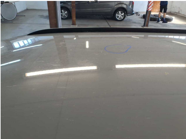
Beschädigung #3: Fahrzeugdach: Dach - Delle(n) - sanft instandsetzen
