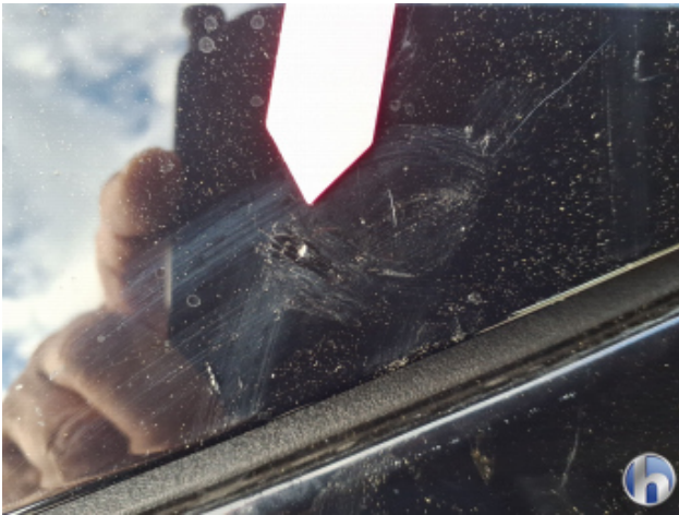
1. Motorhaube Steinschlag - Smart Repair
