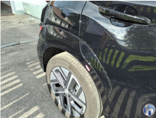
5. Seitenwand - Hinten - Rechts Kratzer - Lackieren
