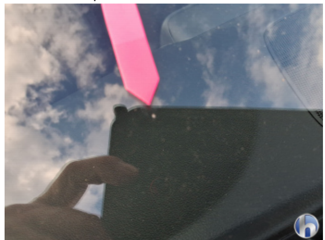
12. Windschutzscheibe Steinschlag - Smart Repair
