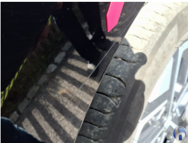
5. Seitenwand - Hinten - Rechts Kratzer - Lackieren
