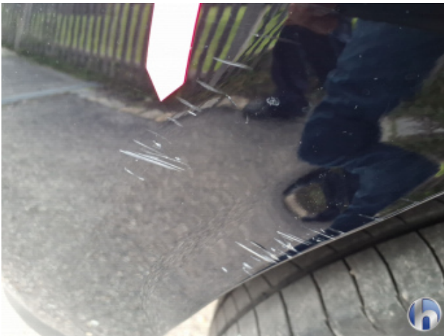
3. Stoßfänger Hinten Kratzer - Instandsetzen und Lackieren
