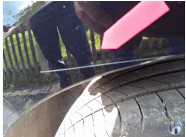
5. Seitenwand - Hinten - Rechts Kratzer - Lackieren
