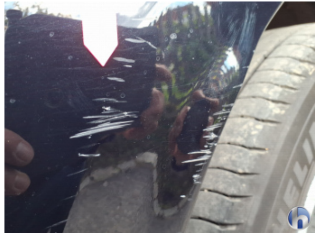
3. Stoßfänger Hinten Kratzer - Instandsetzen und Lackieren
