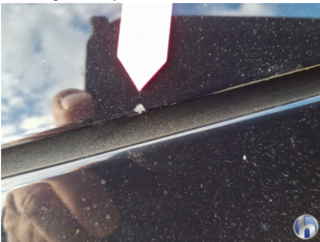
1. Motorhaube Steinschlag - Smart Repair
