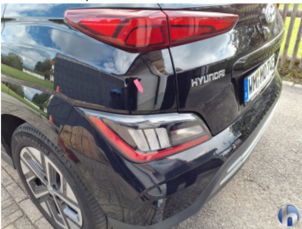
4. Seitenwand - Hinten - Links Kratzer - Smart Repair
