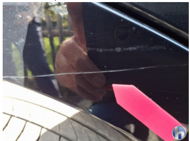
5. Seitenwand - Hinten - Rechts Kratzer - Lackieren
