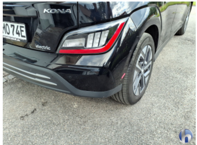
3. Stoßfänger Hinten Kratzer - Instandsetzen und Lackieren
