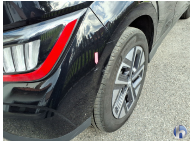
3. Stoßfänger Hinten Kratzer - Instandsetzen und Lackieren
