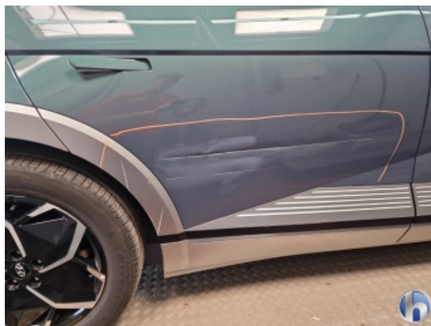
3. Tür Hinten - Rechts Unfallschaden - Siehe Kalkulation
