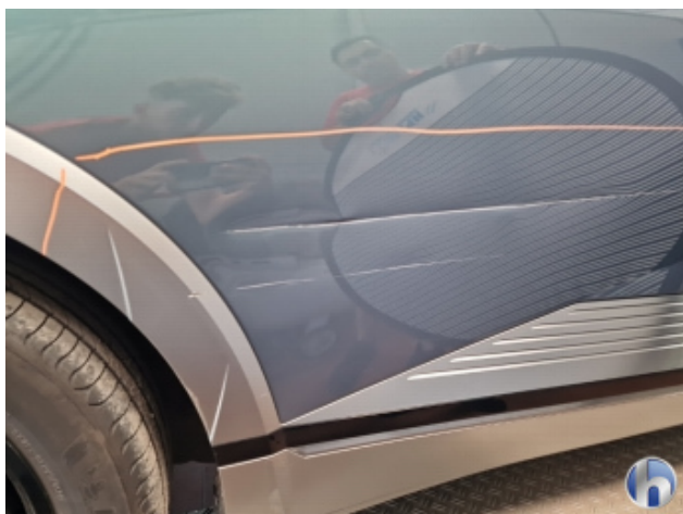
3. Tür Hinten - Rechts Unfallschaden - Siehe Kalkulation
