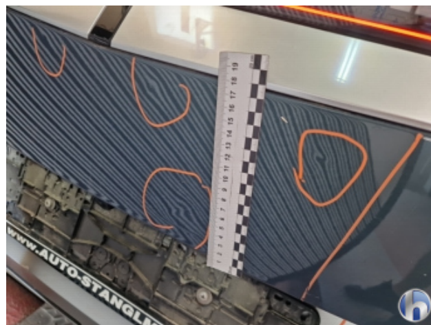
2. Heckklappe Beschädigt - Instandsetzen
