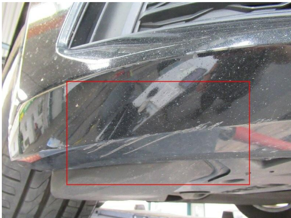
Bild 16 : Stoßfänger vorne Lackierung, Kratzer und viele Steinschläge, lackieren mit Lackaufbau
