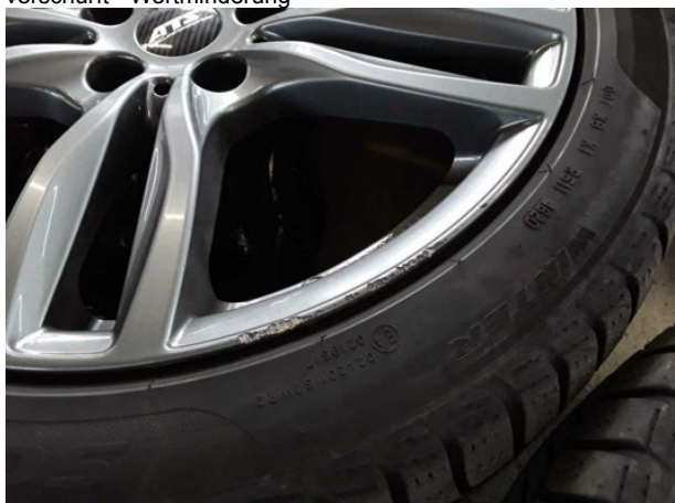
Beschädigung #16: 2.Radsatz: 3 Leichtmetallfelgen - verkratzt / verschürft - Wertminderung
