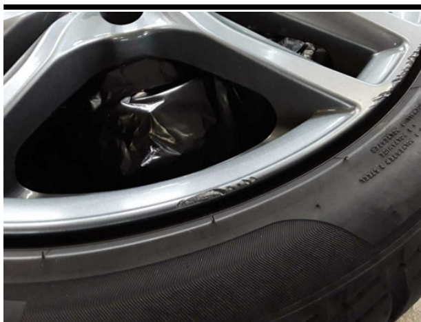
Beschädigung #16: 2.Radsatz: 3 Leichtmetallfelgen - verkratzt / verschürft - Wertminderung
