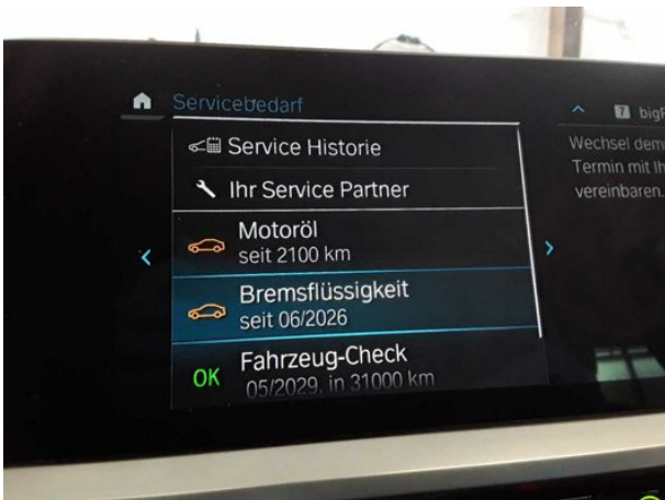
Beschädigung #3: Bremsanlage: Bremsflüssigkeit - fällig - erneuern
