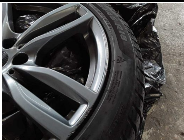
Beschädigung #16: 2.Radsatz: 3 Leichtmetallfelgen - verkratzt / verschürft - Wertminderung
