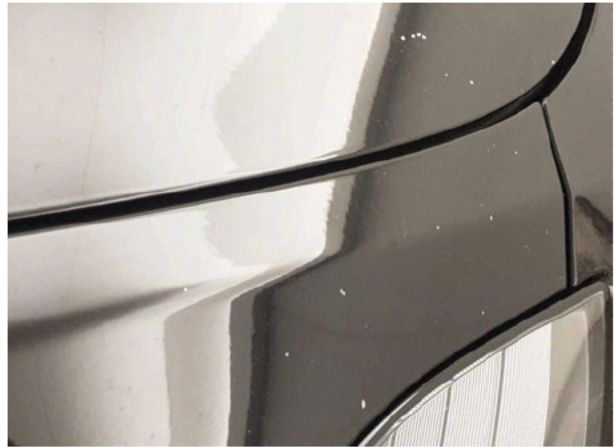
Beschädigung #15: Kotflügel rechts: Kotflügel rechts - Steinschlag - lackieren
