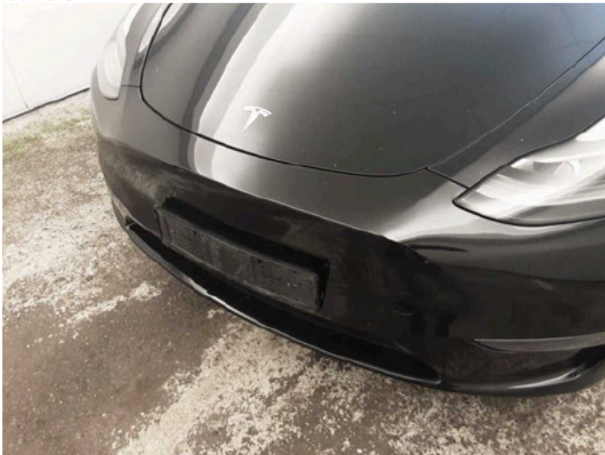
Beschädigung #16: Stossfänger vorn: Stossfänger vorn - Steinschlag... instandsetzen und lackieren
