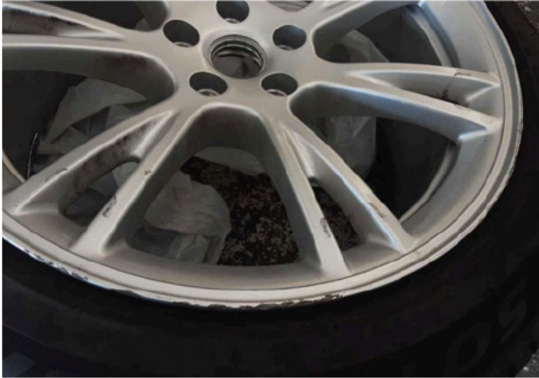
Beschädigung #17: 2.Radsatz: 3 Leichtmetallfelgen - verkratzt / verschürft - instandsetzen und lackieren
