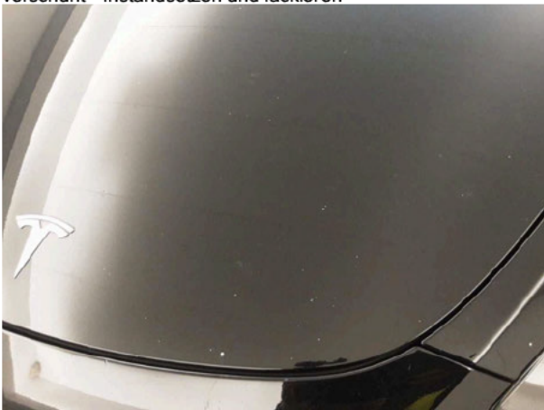
Beschädigung #18: Motorhaube: Motorhaube - Steinschlag - lackieren
