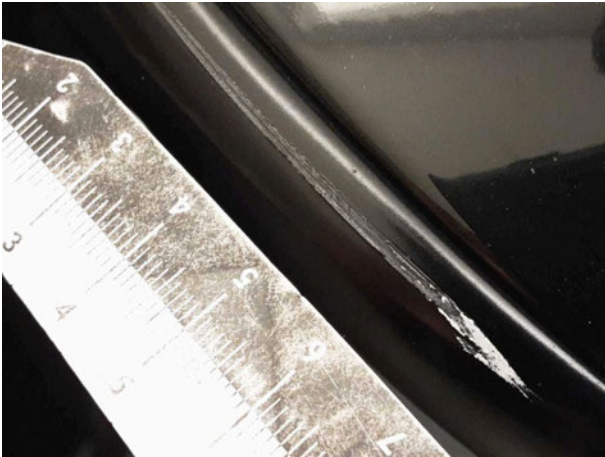
Beschädigung #9: Außenspiegel links: Abdeckkappe - verkratzt / verschürft - erneuern
