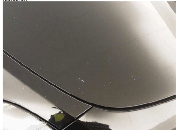
Beschädigung #18: Motorhaube: Motorhaube - Steinschlag - lackieren
