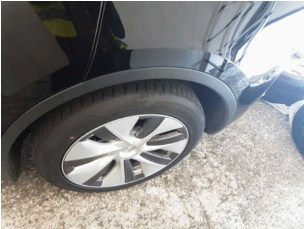
Beschädigung #12: Rad/Reifen: Leichtmetallfelge hinten links - verkratzt / verschürft - erneuern
