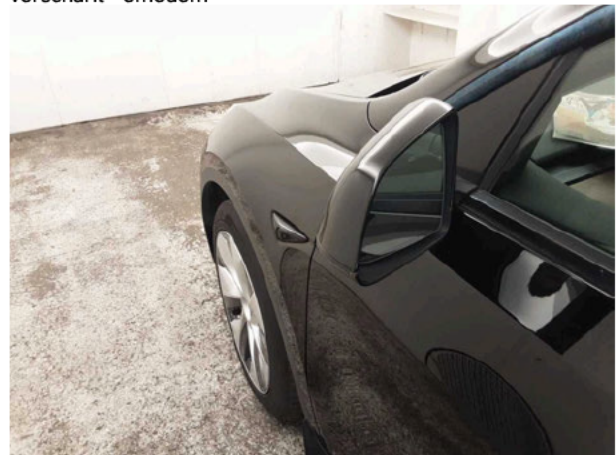
Beschädigung #9: Außenspiegel links: Abdeckkappe - verkratzt / verschürft - erneuern
