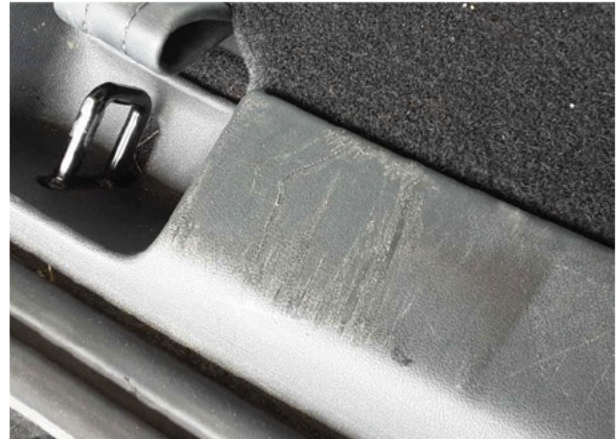
Beschädigung #7: Verkleidungen/Abdeckungen: Verkleidung Ladekante - verkratzt / verschürft - erneuern
