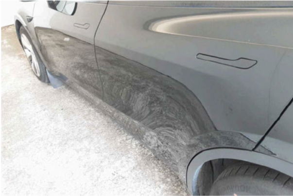
Beschädigung #1: Tür hinten links: Tür - nicht fachgerecht instandgesetzt - sanft instandsetzen
