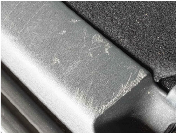
Beschädigung #7: Verkleidungen/Abdeckungen: Verkleidung Ladekante - verkratzt / verschürft - erneuern
