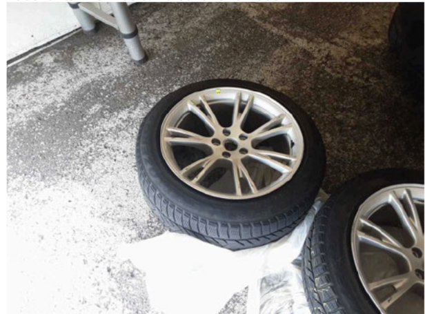
Beschädigung #8: 2.Radsatz: 1 Leichtmetallfelge - verkratzt / verschürft - erneuern
