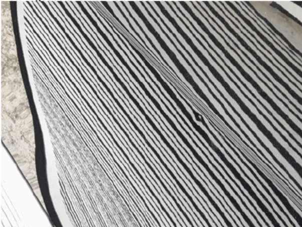
Beschädigung #1: Tür hinten links: Tür - nicht fachgerecht instandgesetzt - sanft instandsetzen
