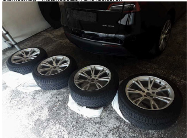
Beschädigung #17: 2.Radsatz: 3 Leichtmetallfelgen - verkratzt / verschürft - instandsetzen und lackieren
