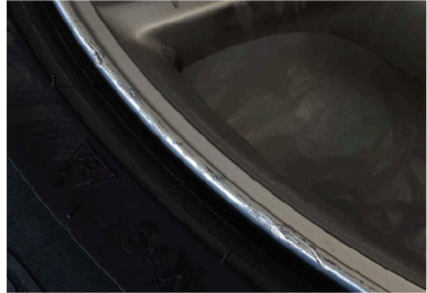
Beschädigung #17: 2.Radsatz: 3 Leichtmetallfelgen - verkratzt / verschürft - instandsetzen und lackieren
