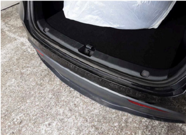
Beschädigung #7: Verkleidungen/Abdeckungen: Verkleidung Ladekante - verkratzt / verschürft - erneuern
