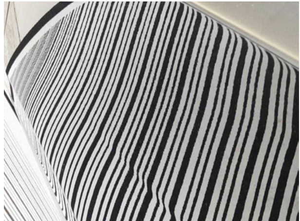
Beschädigung #11: Seitenwand links: Seitenwand - nicht fachgerecht instandgesetzt - lackieren
