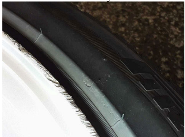
Beschädigung #6: 2.Radsatz: 1 Reifen - gebrochen / gerissen - erneuern
