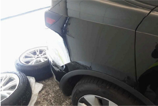
Beschädigung #14: Seitenwand rechts: Seitenwand - Delle / Lackschaden - instandsetzen und lackieren
