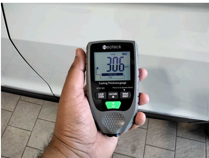
Door - rear left side: 306 µm
