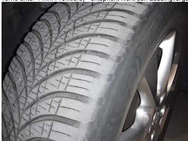
Beschädigung #4: Rad/Reifen: Reifen vorn (2 x Ganzjahresreifen vorne unter 4 mm Profiltiefe) - entspricht nicht den Leasingvorgab...
