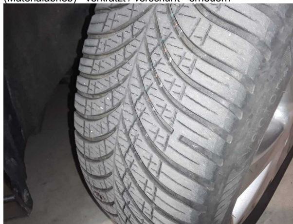
Beschädigung #4: Rad/Reifen: Reifen vorn (2 x Ganzjahresreifen vorne unter 4 mm Profiltiefe) - entspricht nic...
