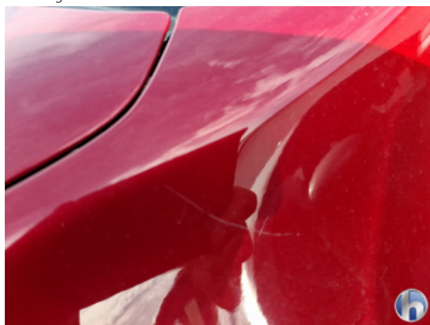
2. Kotflügel Vorne - Links Kratzer - Smart Repair
