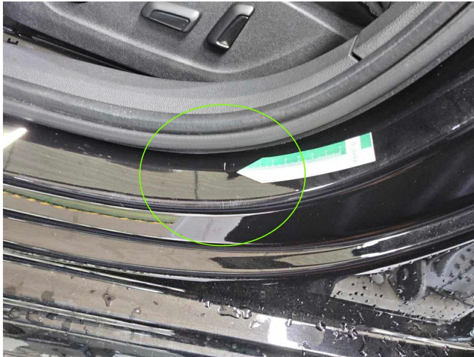
Bild 21 : Tür vorne links Einstieg Lackierung, zerkratzt, lackieren mit Lackaufbau
