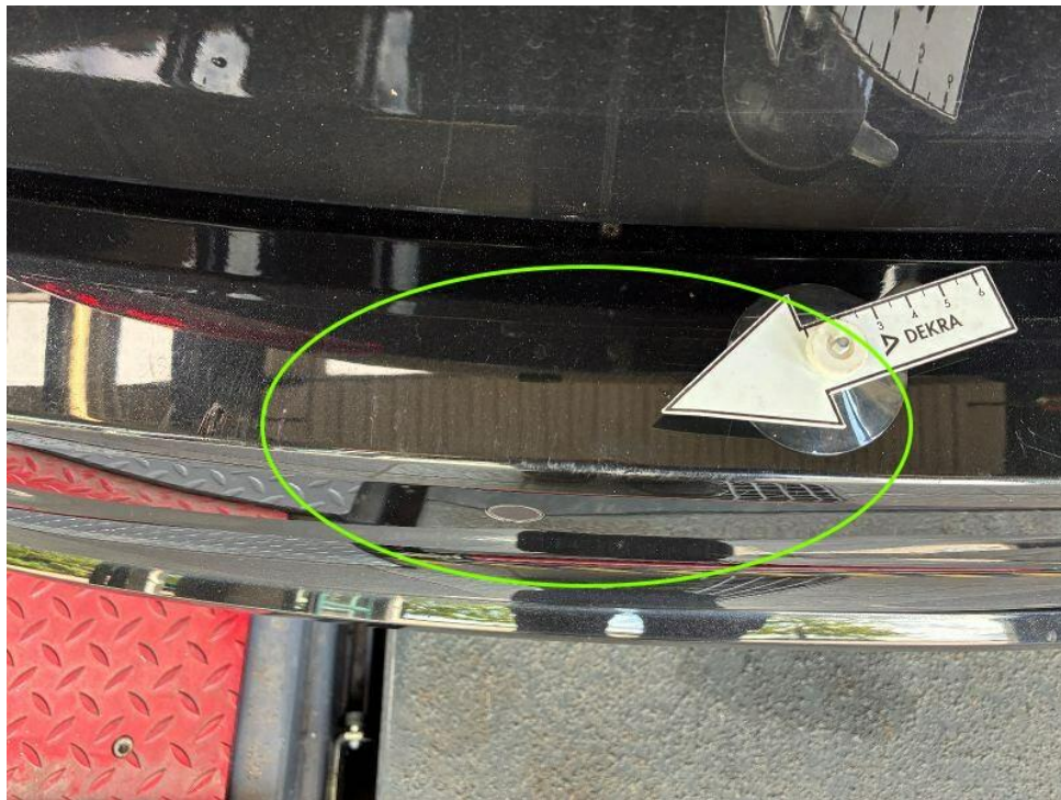
Bild 19 : Stoßfänger hinten, zerkratzt
