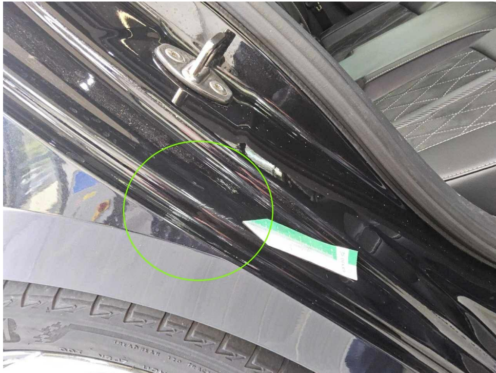
Bild 13 : Tür hinten rechts Einstieg Lackierung, zerkratzt, lackieren mit Lackaufbau
