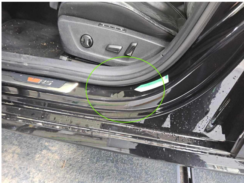
Bild 22 : Tür vorne links Einstieg Lackierung, zerkratzt, lackieren mit Lackaufbau
