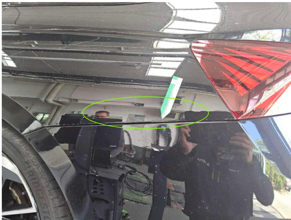
Bild 16 : Seitenteil hinten links Lackierung, zerkratzt, lackieren mit Lackaufbau
