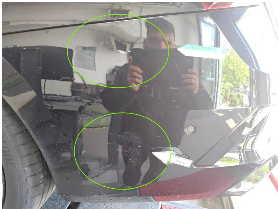
Bild 17 : Stoßfänger hinten, zerkratzt
