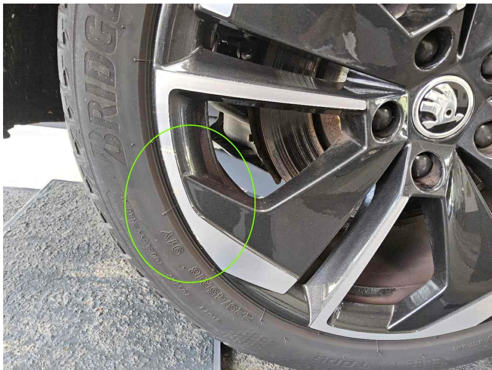
Bild 24 : Glanzgedrehte Aluminiumfelge hinten rechts, zerkratzt
