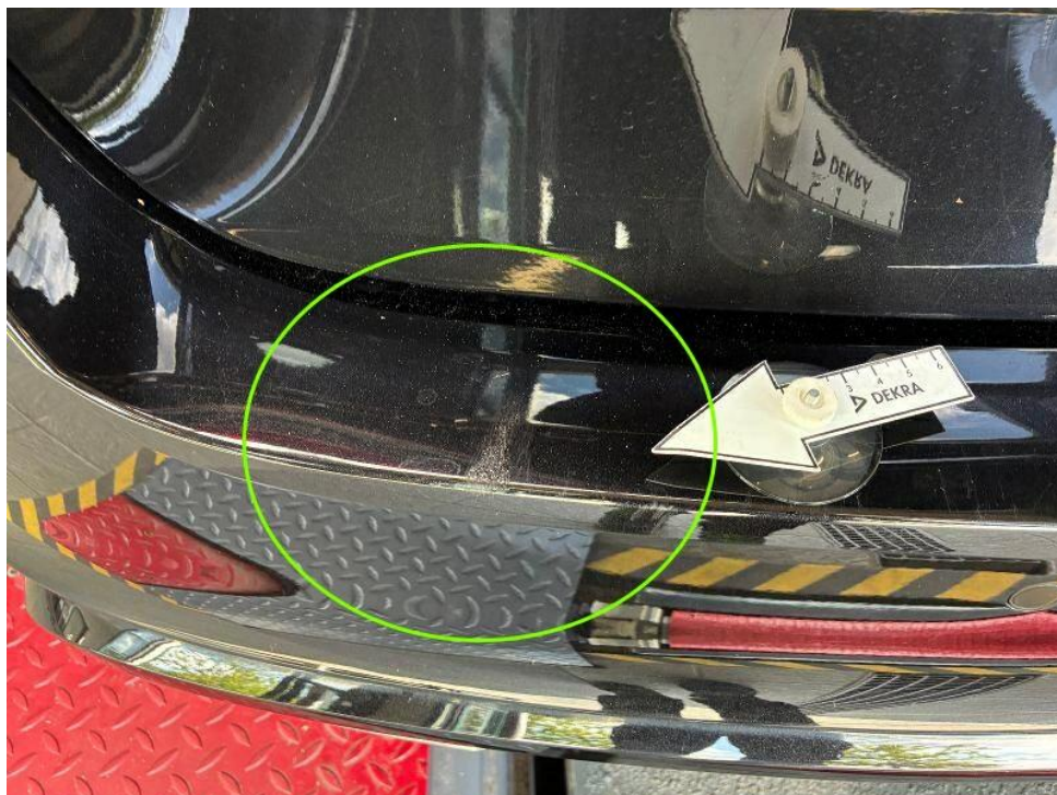
Bild 20 : Stoßfänger hinten, zerkratzt
