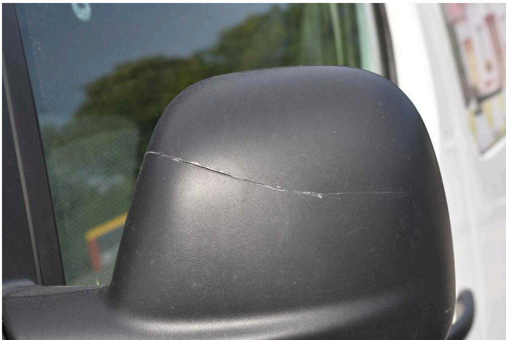
Bild 18 linke Seite Außenspiegelgehäuse links gebrochen
