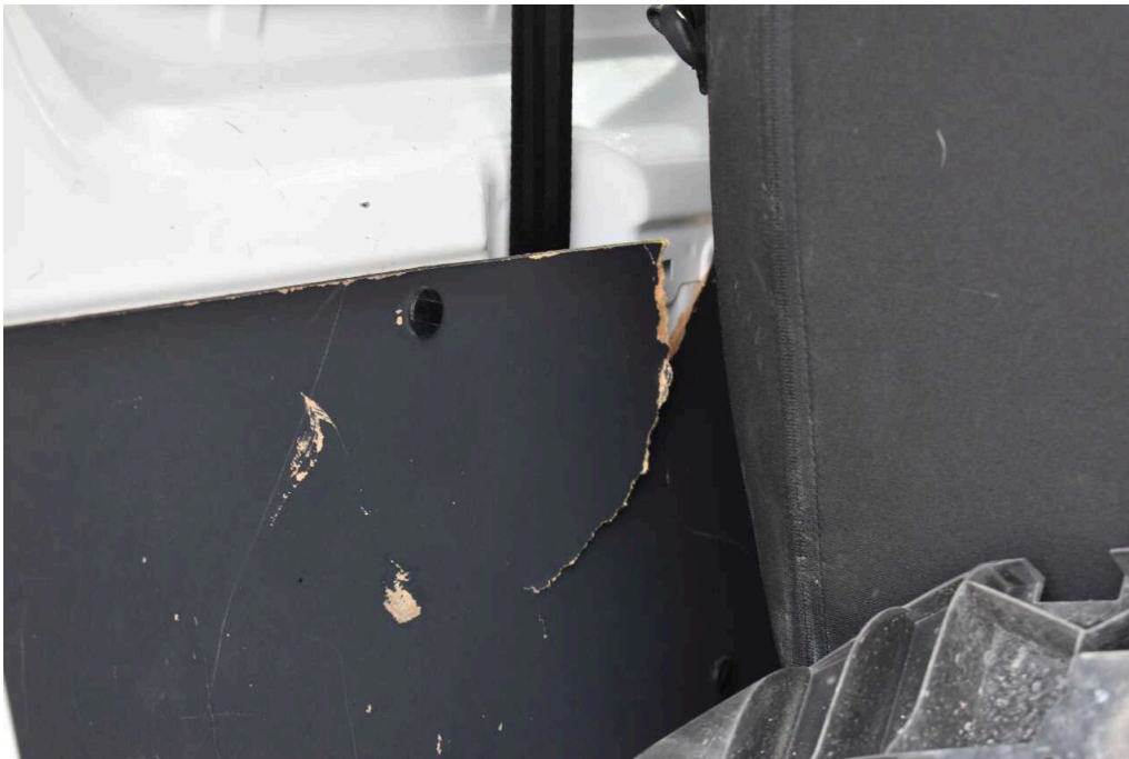
Bild 22 Innenraum div. Laderaumverkleidungen beschädigt
