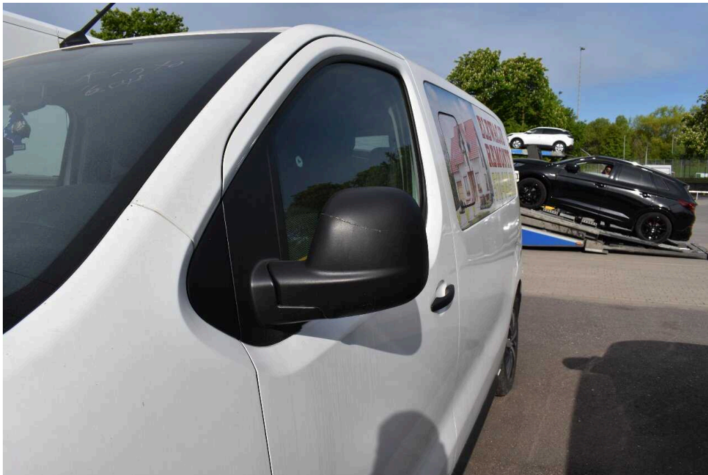
Bild 17 linke Seite Außenspiegelgehäuse links gebrochen
