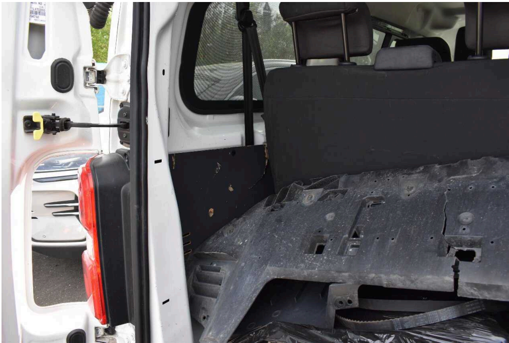
Bild 21 Innenraum div. Laderaumverkleidungen beschädigt
