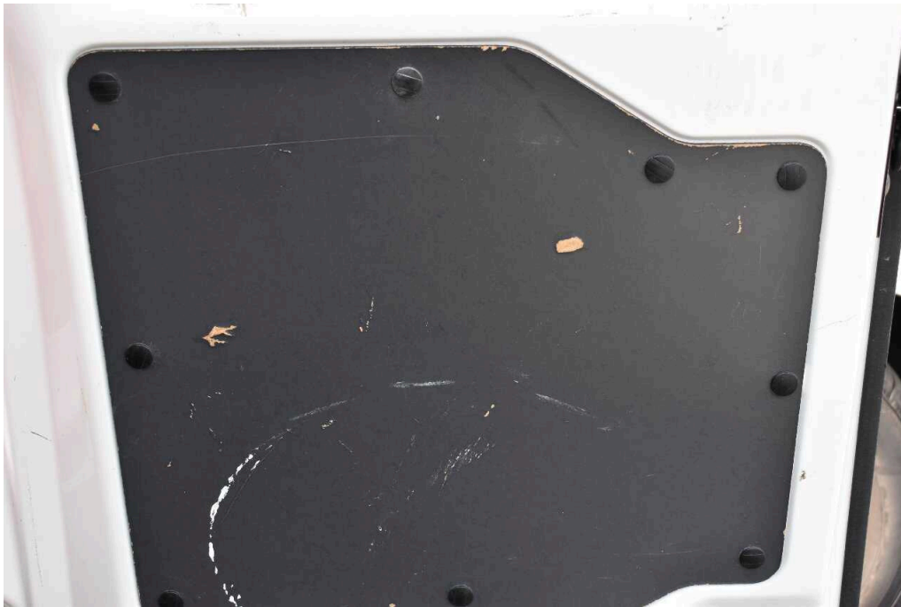
Bild 23 Innenraum div. Laderaumverkleidungen beschädigt
