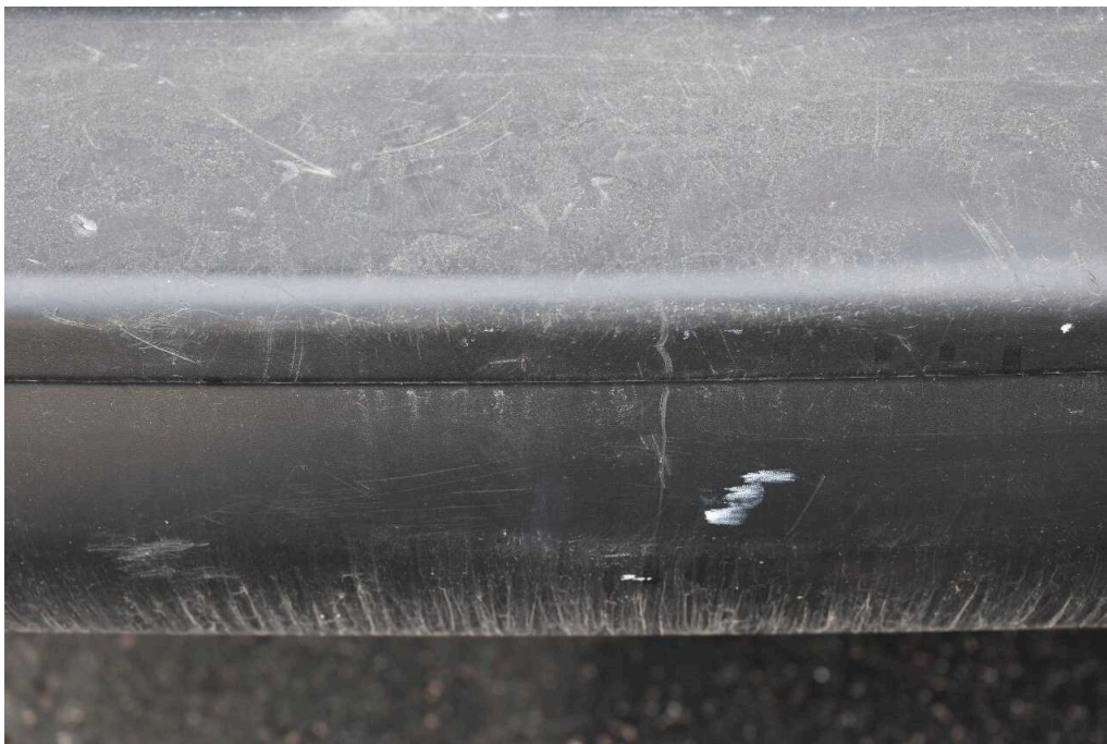
Bild 30 Fahrzeugheck Stoßfänger hinten Kratzer
