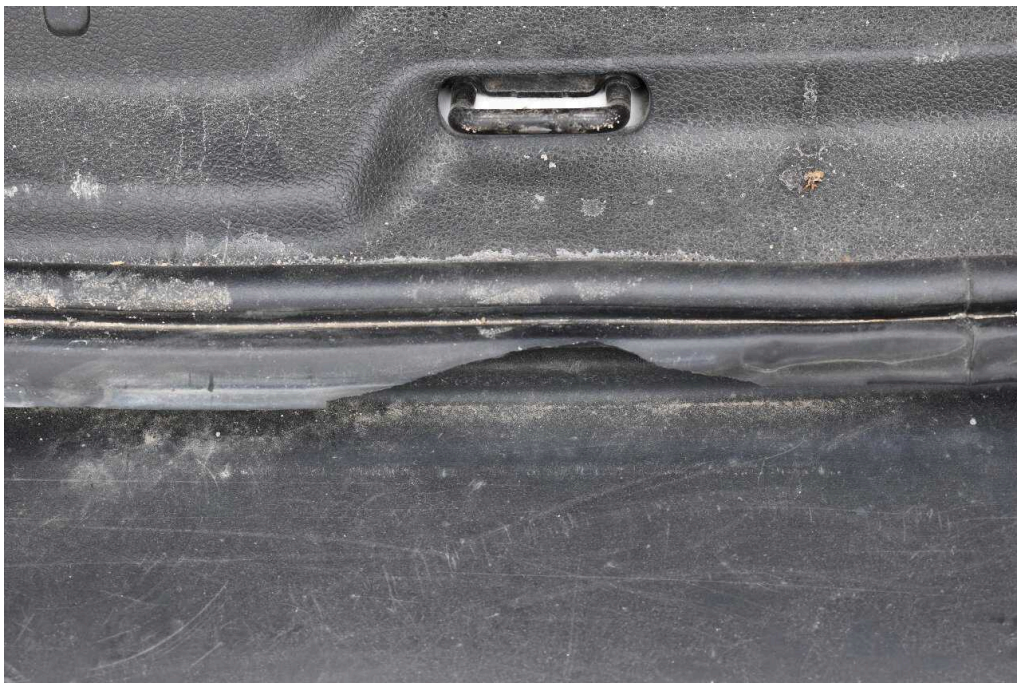
Bild 28 Fahrzeugheck Heckklappendichtung gerissen / eingerissen
