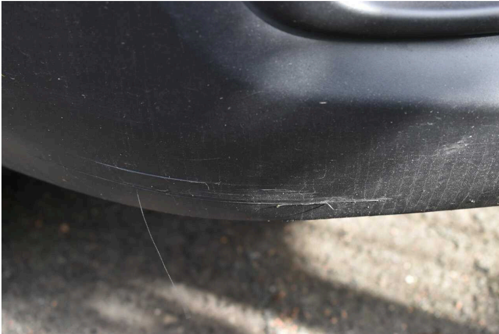
Bild 15 Fahrzeugfront Stoßfänger vorne verkratzt
