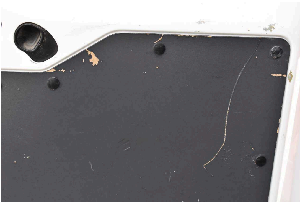
Bild 26 Innenraum div. Laderaumverkleidungen beschädigt
