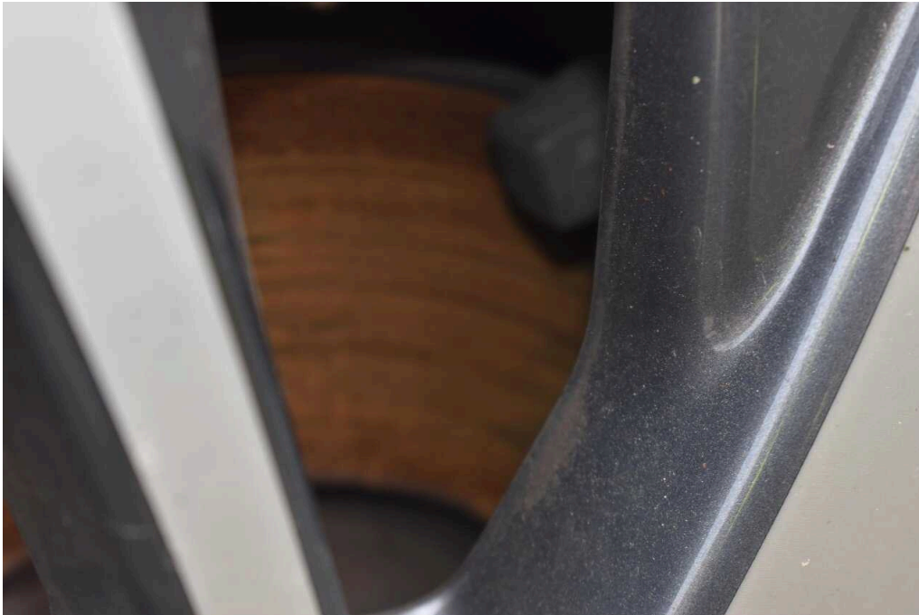
Bild 33 Vorderachse Bremsbeläge / Bremsscheiben vorne links verschlissen
