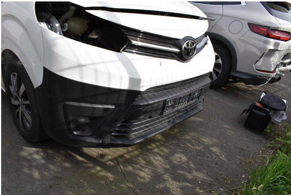
Bild 14 Fahrzeugfront Stoßfänger vorne verkratzt
