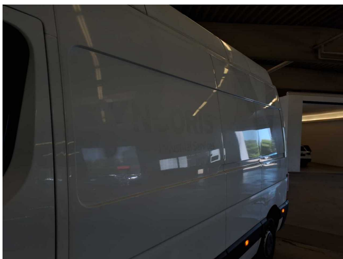
Damage 8: Body: Body (Ausbleichungen) - Glued / labelled - Conditioning
