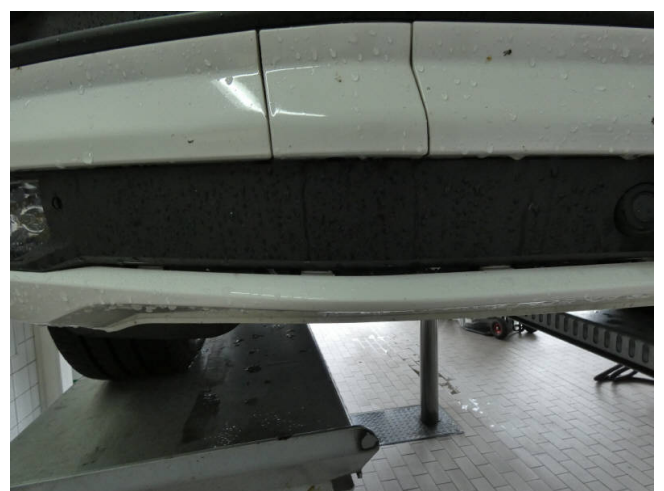
Stoßstange V Verformt - Ern.
