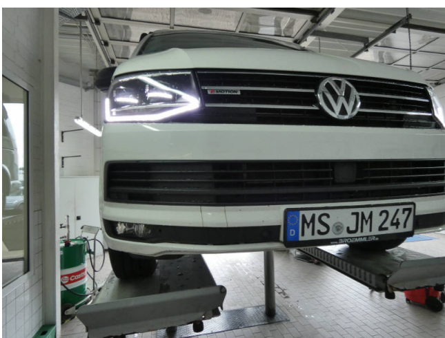
Stoßstange V Verformt - Ern.
