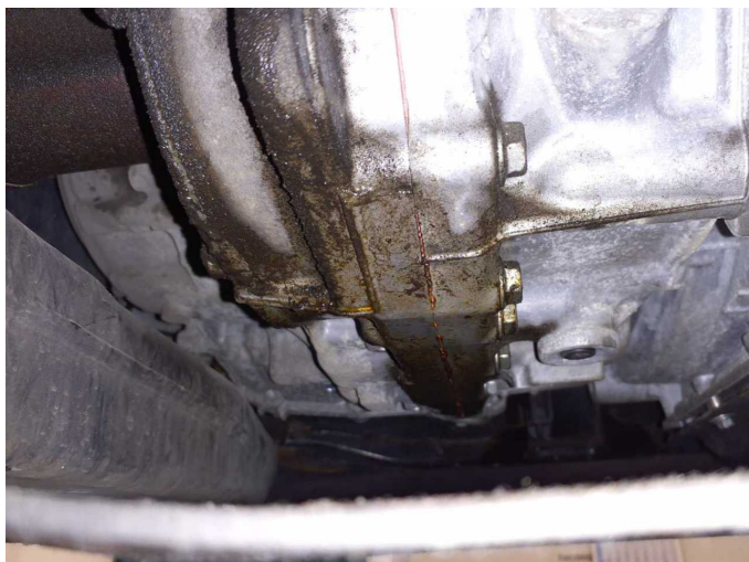
Damage 2: Engine: Engine (Kostenausweitung möglich) - Leaking - Perform diagnosis
