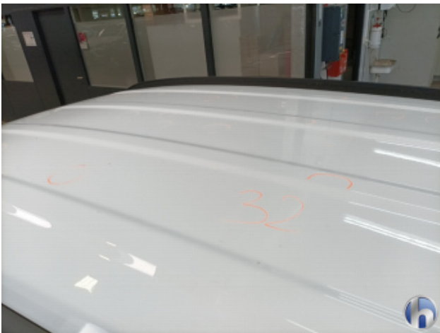
1. Dach Hagelschaden - Sanft Instandsetzen
