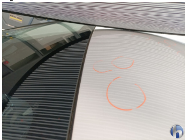
1. Dach Hagelschaden - Sanft Instandsetzen
