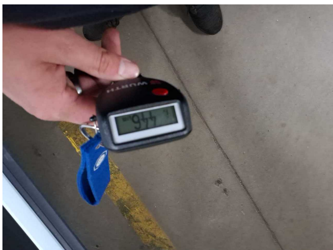
Door - rear right side: 446 \mu\text{m}
