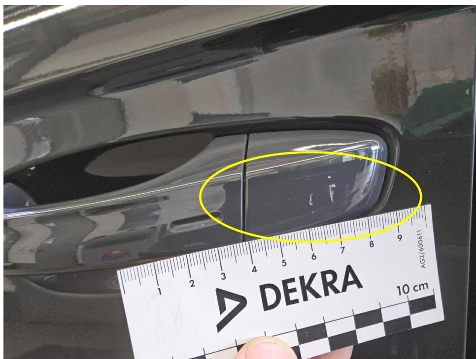
Bild 12 : Tür vorne links Türgriff, zerkratzt, lackieren mit Lackaufbau
