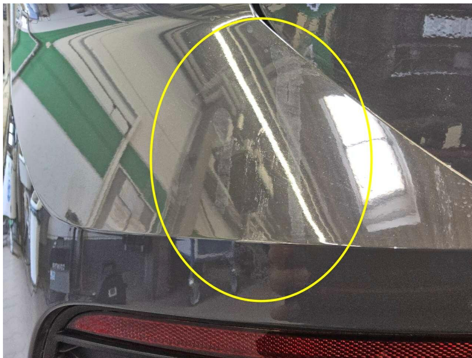
Bild 18 : Lackzustand mehrfach Umweltschaden, Lackaufbereitung
