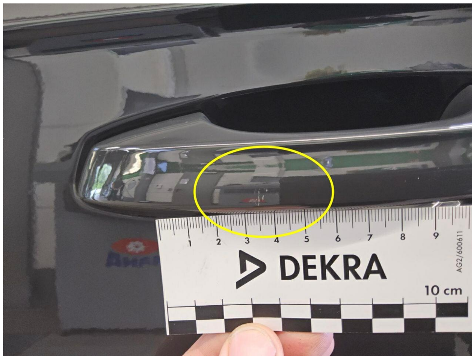
Bild 13 : Tür vorne links Türgriff, zerkratzt, lackieren mit Lackaufbau
