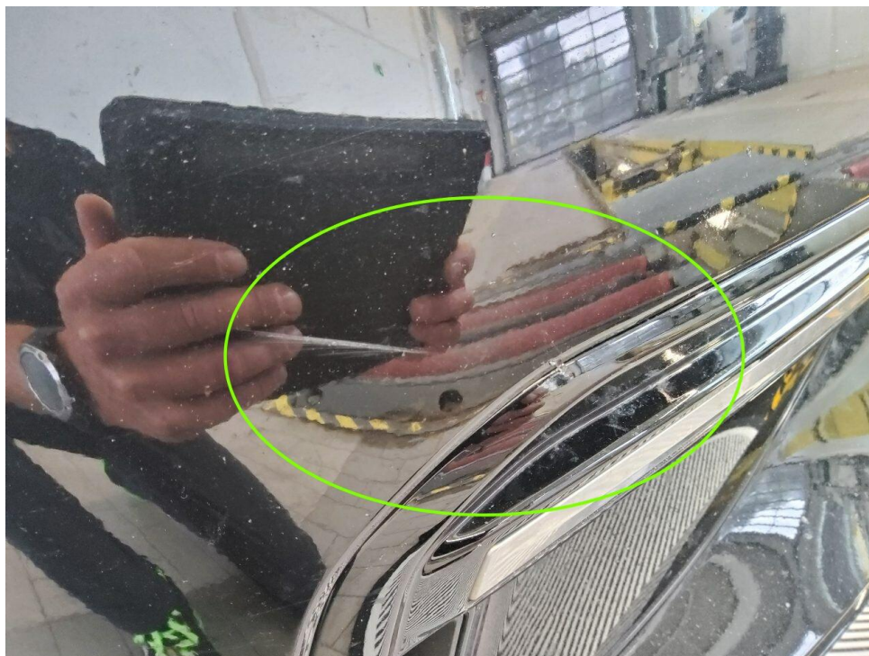
Bild 9 : Stoßfänger vorne Lackierung, zerkratzt, smart repair
