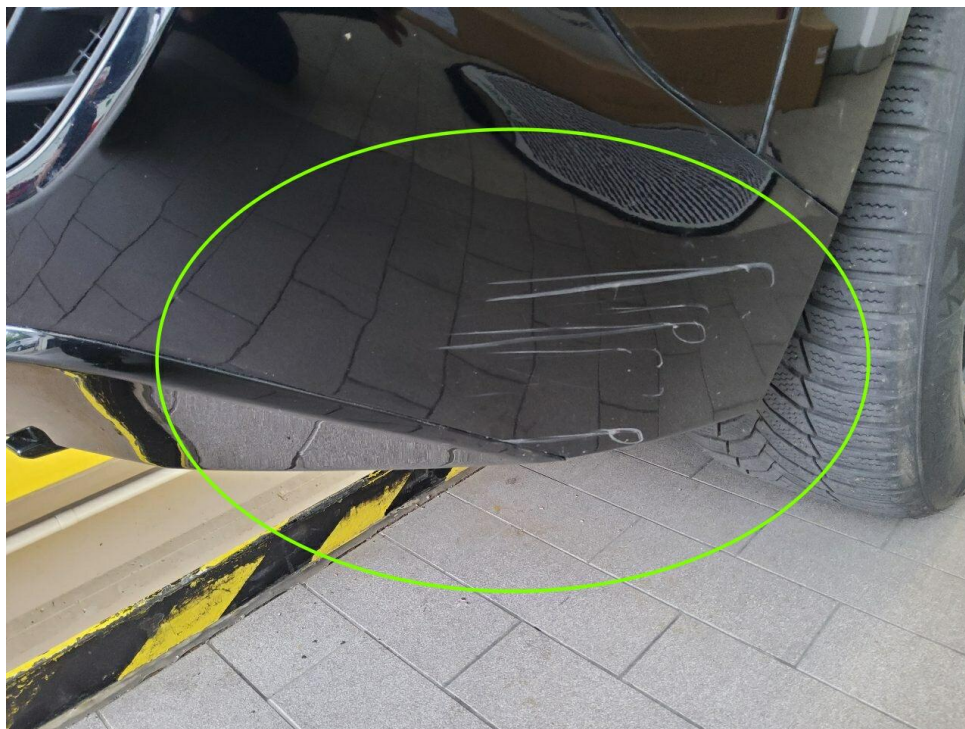
Bild 11 : Stoßfänger hinten Lackierung, zerkratzt, lackieren mit Lackaufbau
