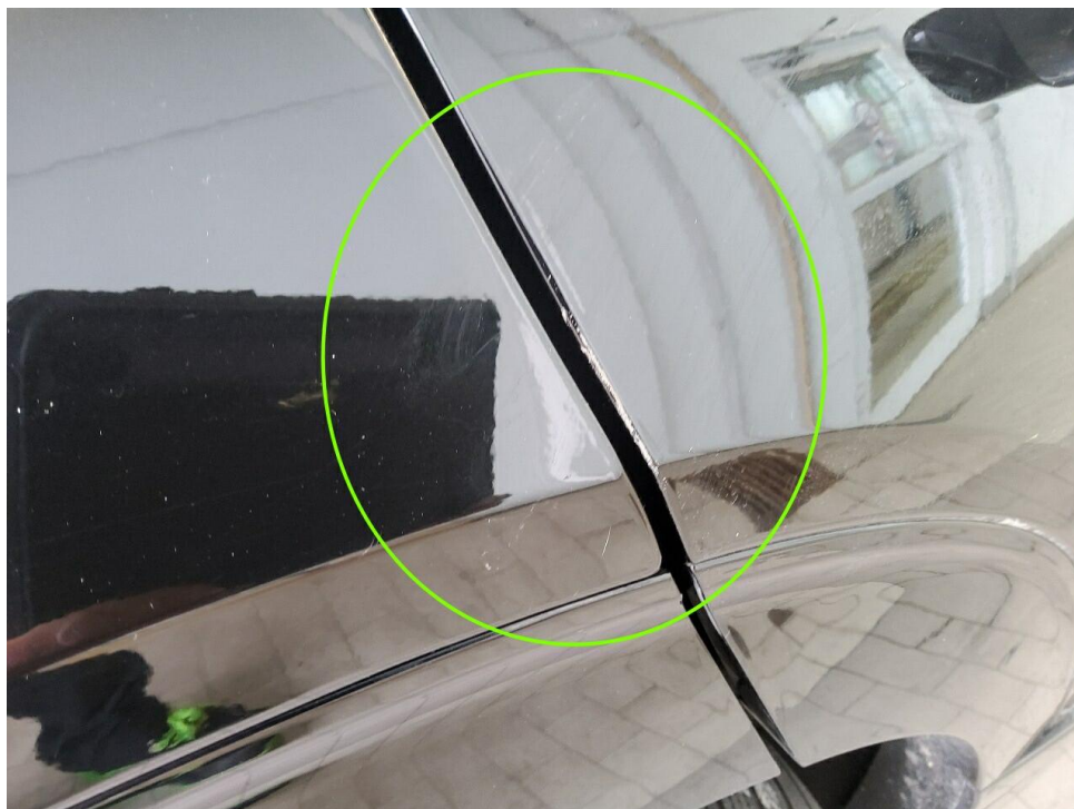
Bild 10 : Tür hinten rechts Türkante, zerkratzt, smart repair
