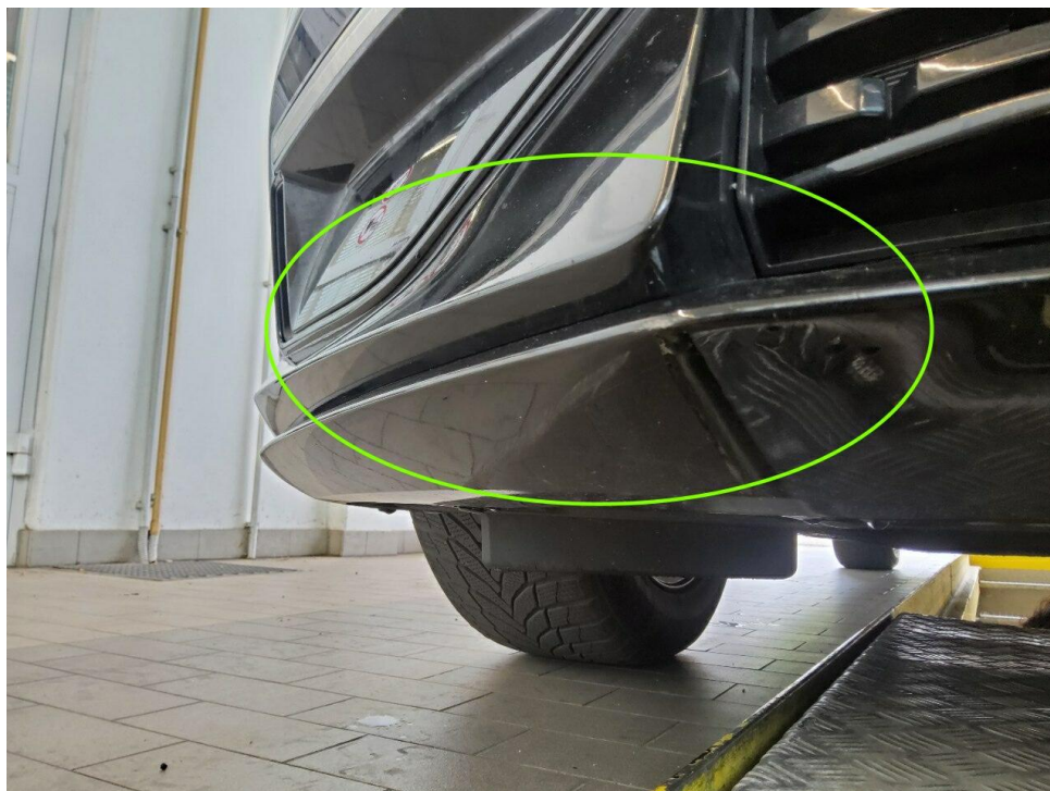
Bild 8 : Stoßfänger vorne Lackierung, zerkratzt, smart repair
