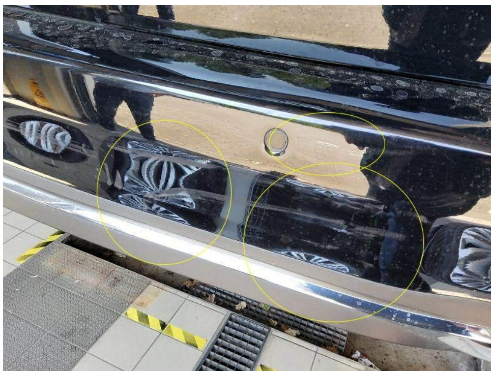
Bild 18 : Heckstoßfängerverkleidung rechts verschrammt und gebrochen - Unfallschaden
