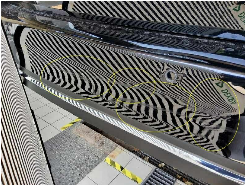
Bild 21 : Heckstoßfängerverkleidung rechts verschrammt und gebrochen - Unfallschaden
