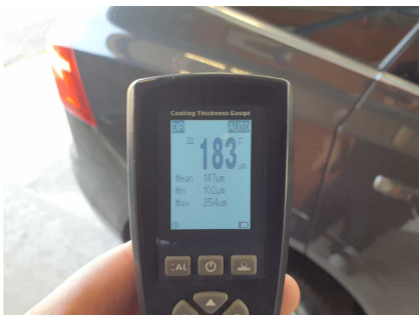
Nachlackierung 2: Seitenwand rechts
