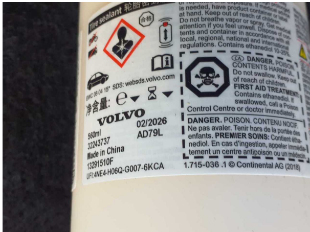
Beschädigung #2: Ausrüstung: Tirefit Füllmittel - abgelaufen - erneuern
