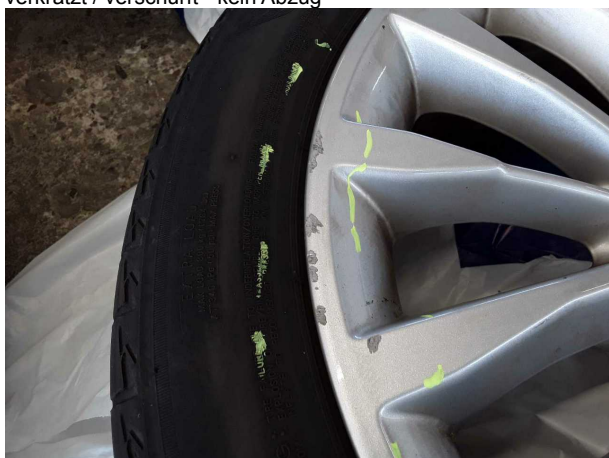
Beschädigung #4: 2.Radsatz: 1 Leichtmetallfelge - verkratzt / verschürft - Wertminderung
