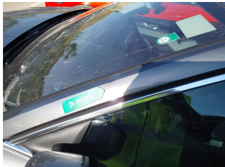
Poste de techo A / B / C / Izquierda / Abolladura
