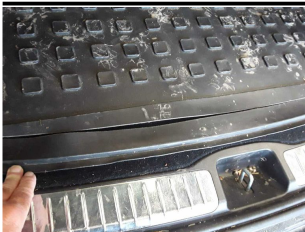
Beschädigung #9: Verkleidungen/Abdeckungen: Kofferraumverkleidung (Ladeboden Formmatte) - gebrochen /
