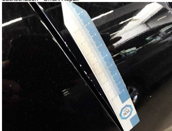
Beschädigung #7: Tür hinten rechts: Türkante - verkratzt / verschürft - Smart Repair
