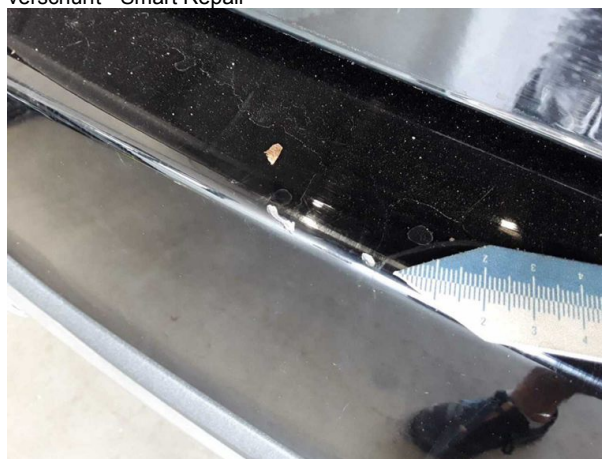
Beschädigung #8: Stossfänger hinten: Stossfänger hinten - verkratzt / verschürft - Smart Repair
