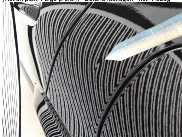
Beschädigung #4: Seitenwand links: Seitenwand - Delle(n) - sanft instandsetzen
