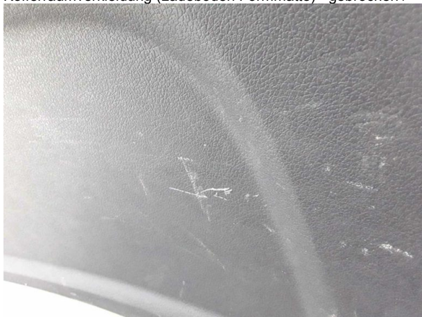
Beschädigung #11: Verkleidungen/Abdeckungen: Heckdeckel, Innenverkleidung - verkratzt / verschürft - erneuern
