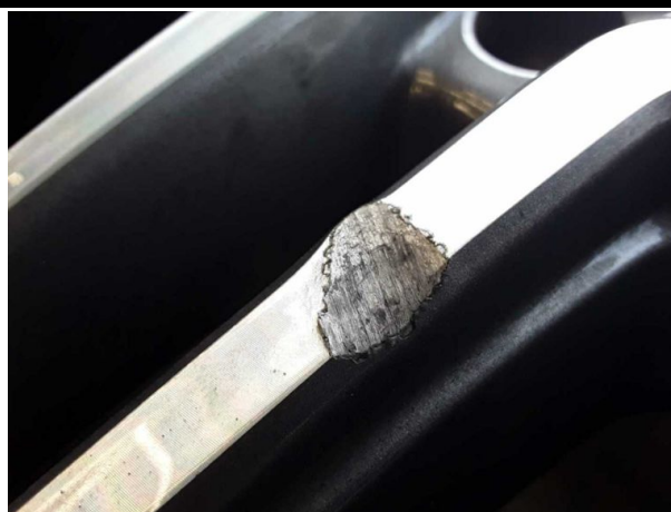
Beschädigung #10: 2.Radsatz: 1 Leichtmetallfelge - verformt - Wertminderung
