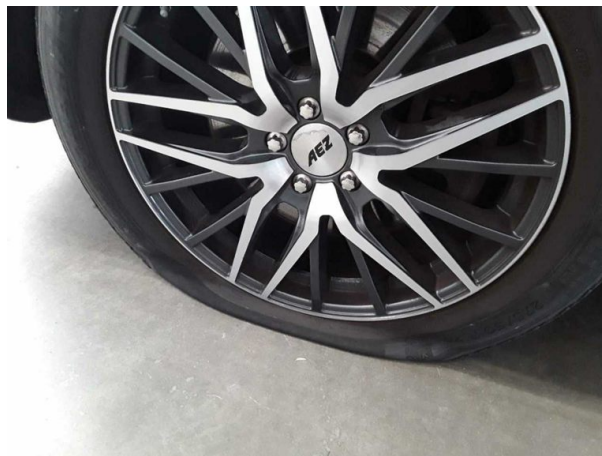
Beschädigung #2: Rad/Reifen: Leichtmetallfelge vorn links (Reifen platt; Felge prüfen) - Befund festlegen - kein Abzug
