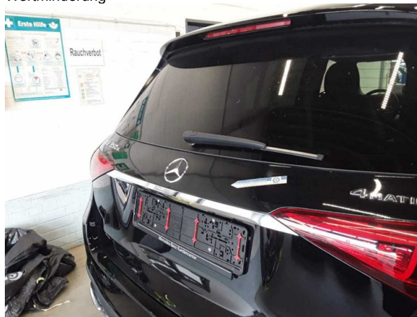
Beschädigung #12: Heckklappe/-tür: Heckklappe (4x) - Delle(n) - instandsetzen und lackieren
