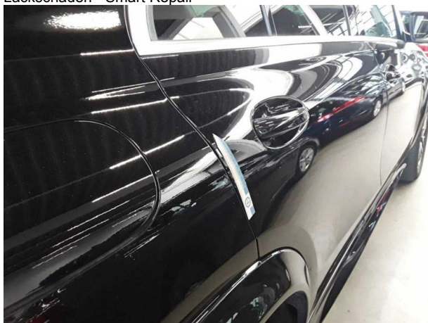
Beschädigung #7: Tür hinten rechts: Türkante - verkratzt / verschürft - Smart Repair
