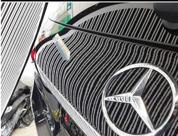
Beschädigung #12: Heckklappe/-tür: Heckklappe (4x) - Delle(n) - instandsetzen und lackieren
