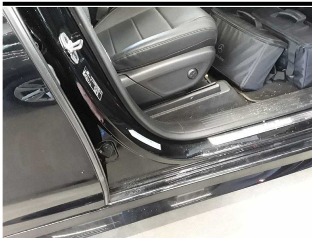
Beschädigung #6: Schweller rechts: Einstieg - Delle / Lackschaden - Smart Repair
