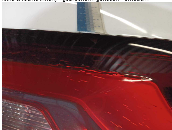
Beschädigung #4: Heckklappe/-tür: Heckklappe (Heckleuchten links & rechts innen) - gebrochen / gerissen - erneuern
