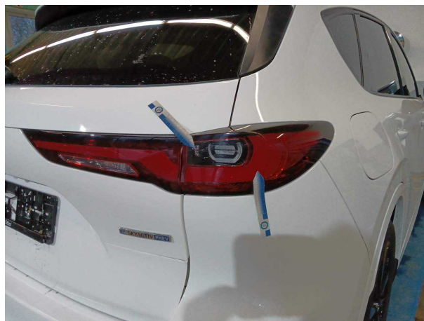
Beschädigung #3: Heckleuchte: Heckleuchte rechts (außen) - gebrochen / gerissen - erneuern
