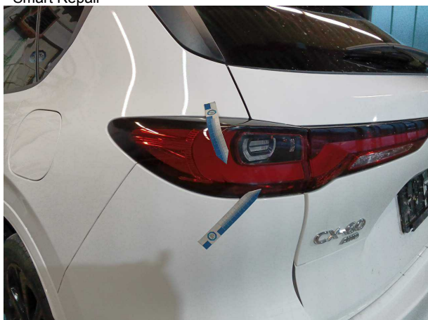
Beschädigung #2: Heckleuchte: Heckleuchte links (außen) - gebrochen / gerissen - erneuern
