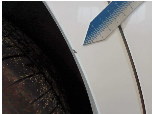
Beschädigung #1: Seitenwand rechts: Radhausverbreiterung - Kratzer - Smart Repair
