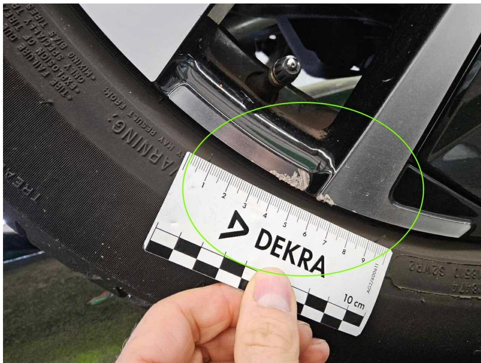
Bild 23 : Felge hinten links, verschrammt, Minderwert
