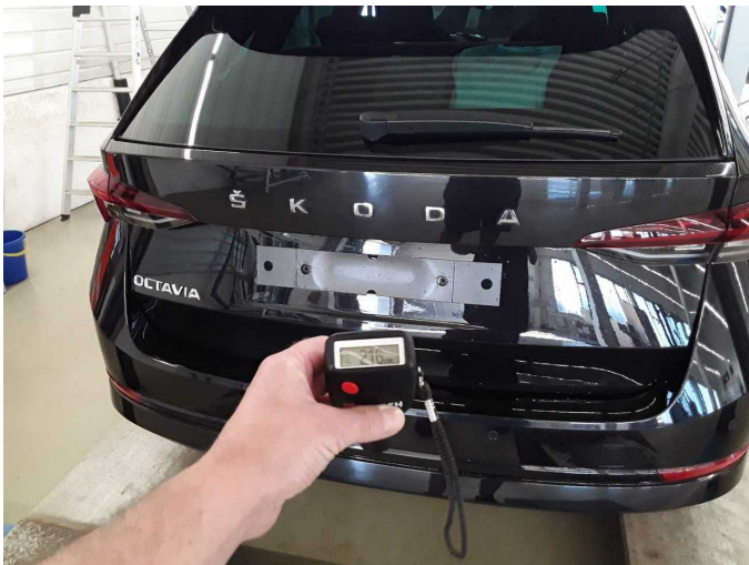
Boot lid / rear door: 216 \mu\text{m}
