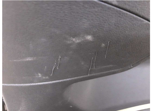
Beschädigung #3: Verkleidungen/Abdeckungen: Heckdeckel, Innenverkleidung - verkratzt / verschürft - Wertminderung
