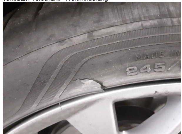
Beschädigung #6: Rad/Reifen: Reifen vorn rechts - gebrochen / gerissen - erneuern
