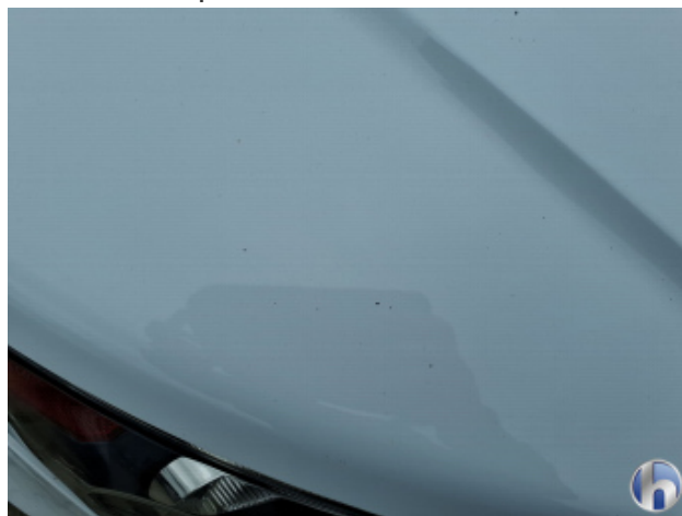
5. Motorhaube Steinschlag - Lackieren
