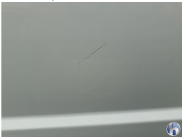
4. Seitenwand - Hinten - Links Kratzer - Smart Repair
