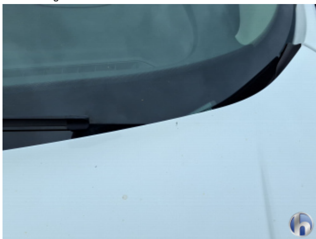
5. Motorhaube Steinschlag - Lackieren
