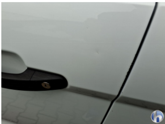
3. Tür Vorne - Links Beschädigt - Smart Repair
