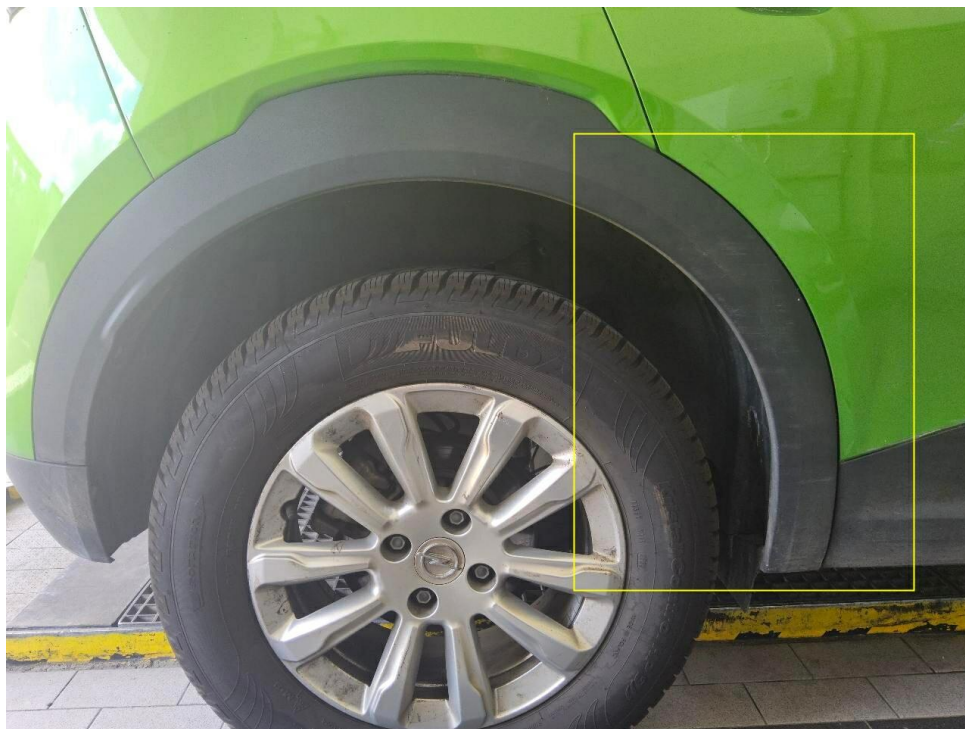
Bild 41 : Seitenschaden rechts, deformiert / zerkratzt (Verbreiterung hinten rechts)
