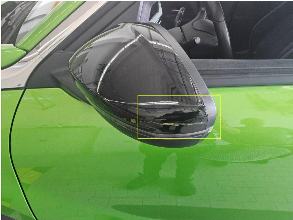
Bild 29 : Seitenschaden links, zerkratzt / deformiert (Außenspiegel links)
