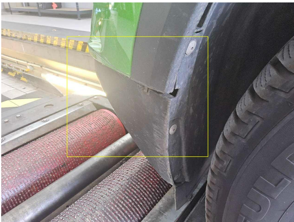
Bild 16 : Seitenschaden links, zerkratzt / deformiert (Stoßfänger vorne)
