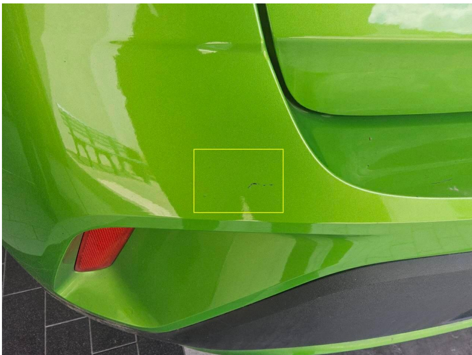
Bild 50 : Stoßfänger hinten Lackierung, zerkratzt, lackieren mit Lackaufbau
