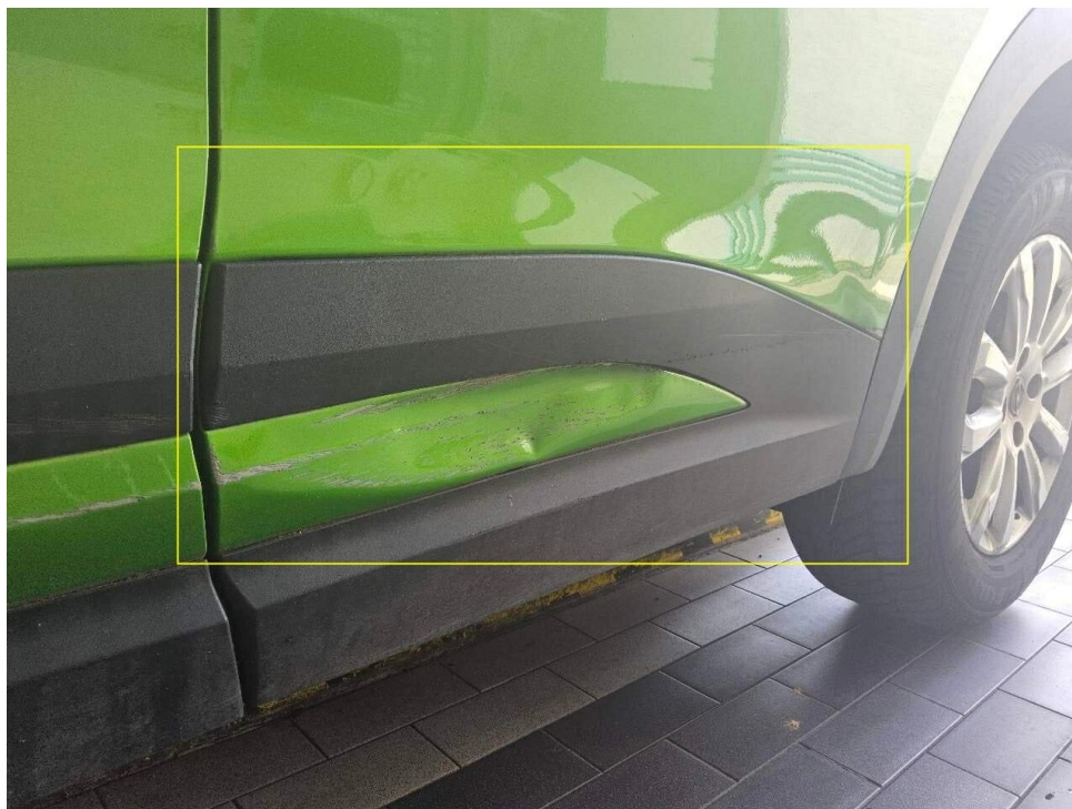
Bild 25 : Seitenschaden links, zerkratzt / deformiert (Tür hinten links)
