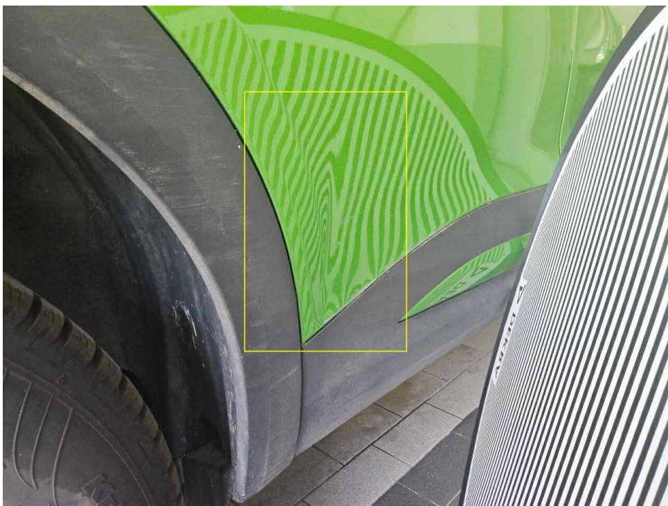
Bild 40 : Seitenschaden rechts, deformiert / zerkratzt (Tür hinten rechts)
