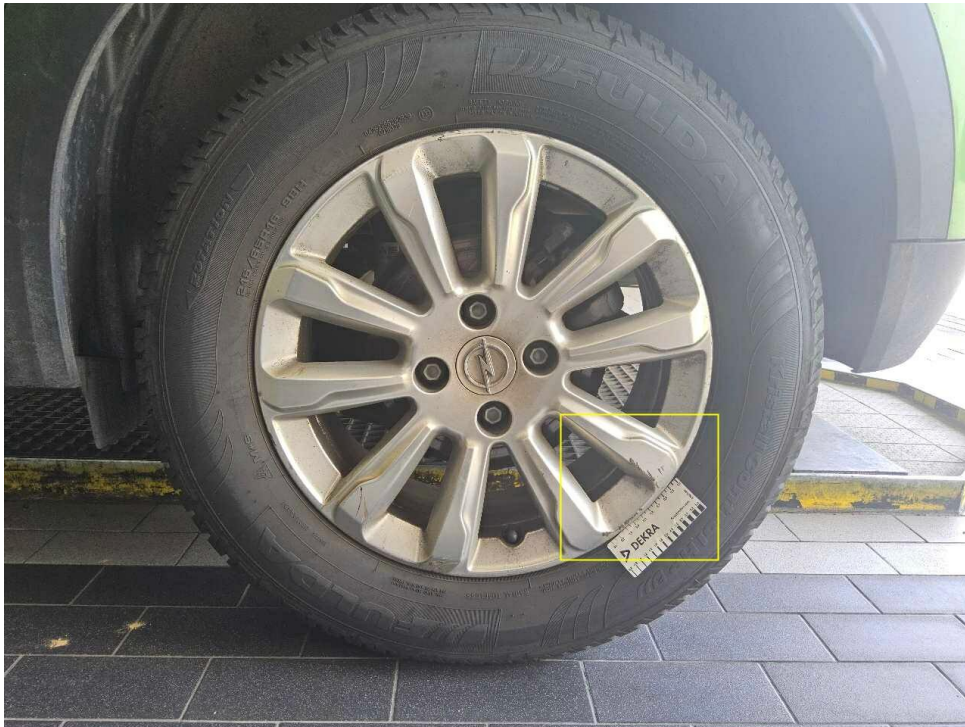
Bild 57 : Felge hinten links, zerkratzt
