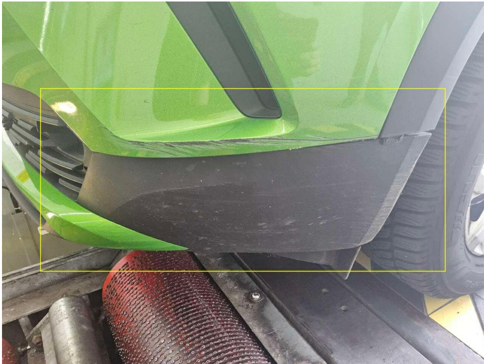
Bild 15 : Seitenschaden links, zerkratzt / deformiert (Stoßfänger vorne)
