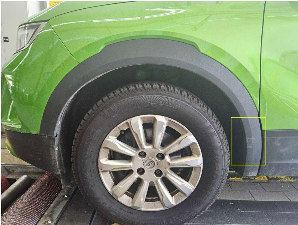
Bild 17 : Seitenschaden links, zerkratzt / deformiert (Verbreiterung vorne links)
