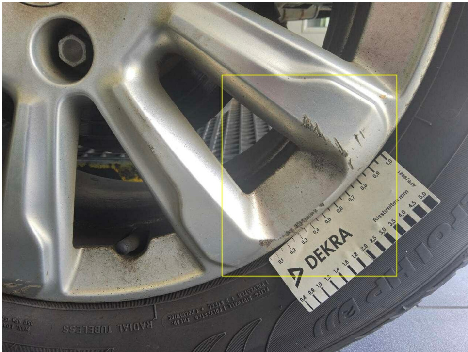
Bild 58 : Felge hinten links, zerkratzt
