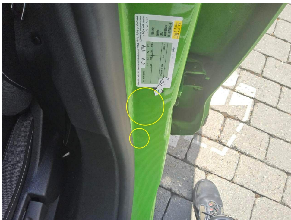
Bild 62 : Tür vorne links Einstieg, eingedellt
