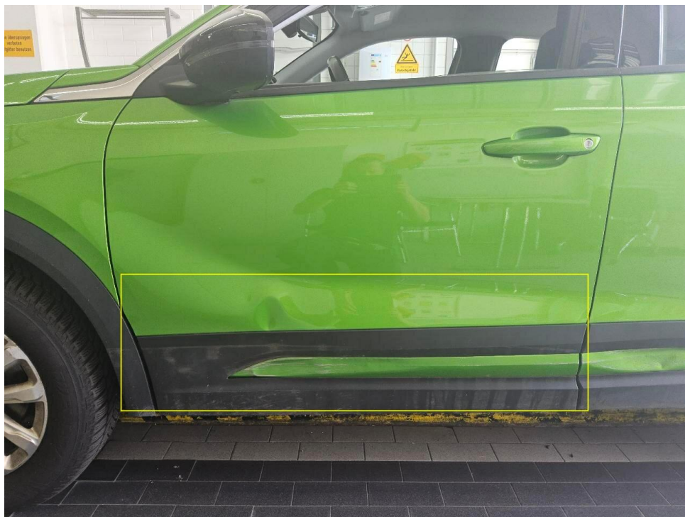
Bild 19 : Seitenschaden links, zerkratzt / deformiert (Tür vorne links)
