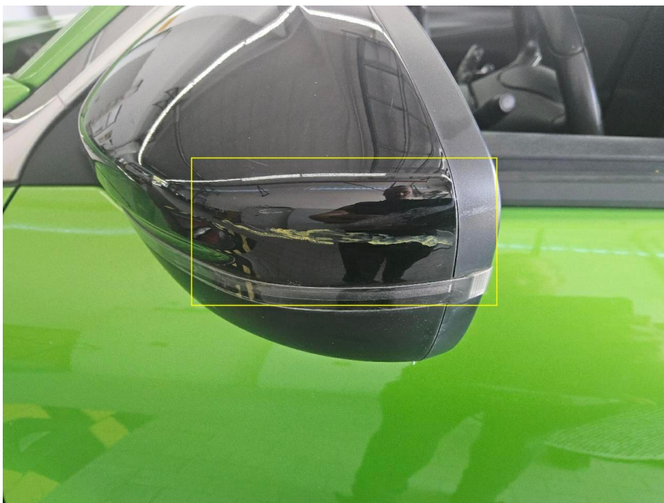
Bild 30 : Seitenschaden links, zerkratzt / deformiert (Außenspiegel links)
