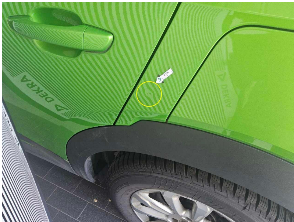
Bild 44 : Seitenteil hinten links, eingedellt
