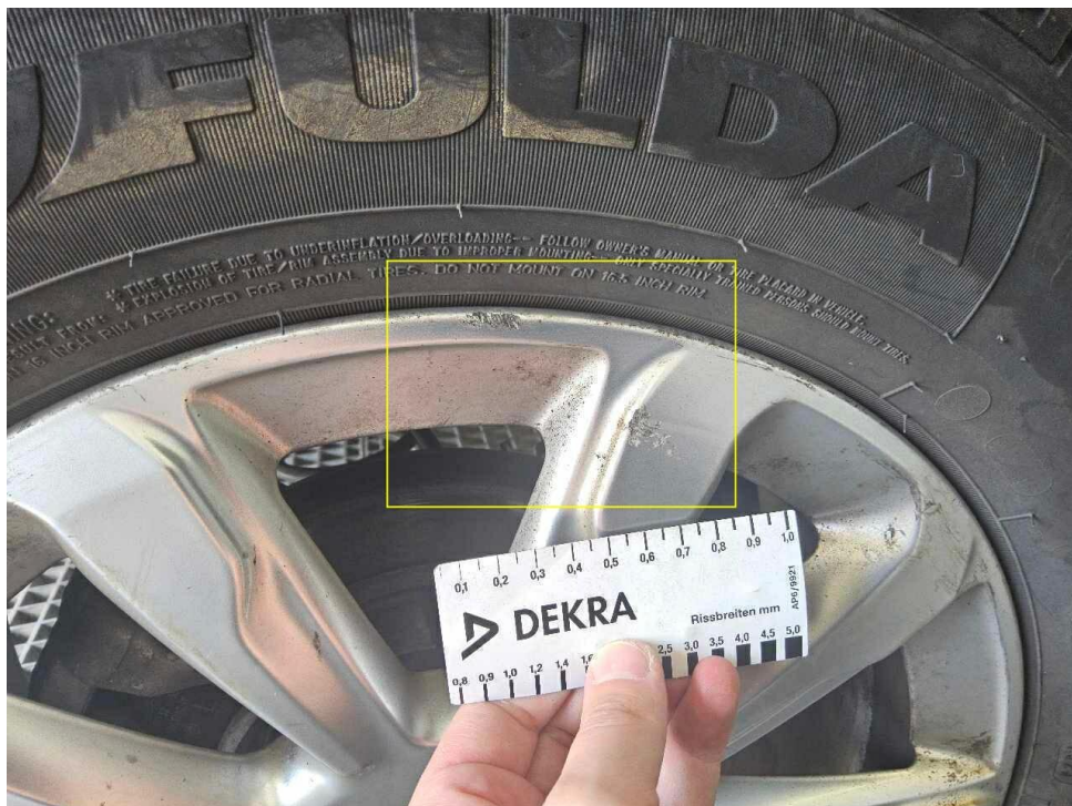
Bild 60 : Felge hinten rechts, zerkratzt
