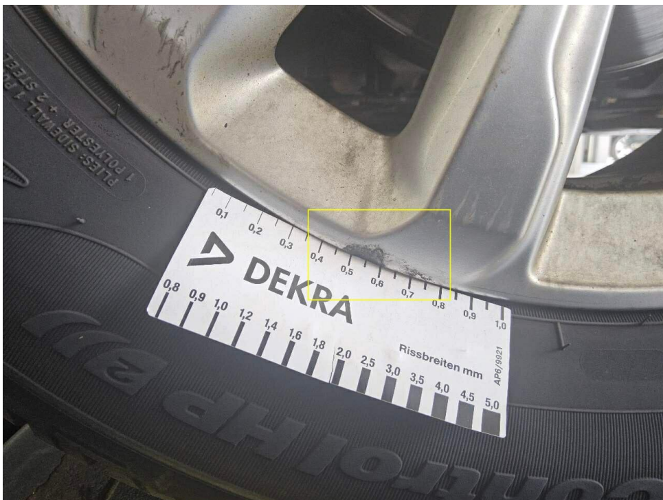
Bild 56 : Felge vorne links, zerkratzt
