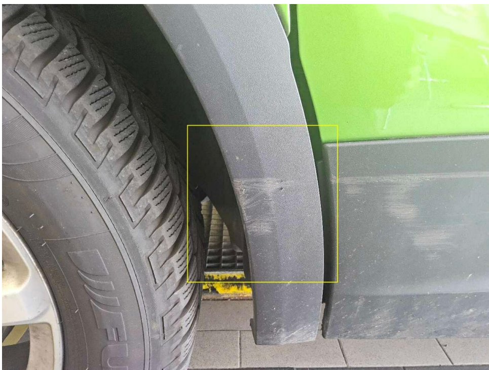
Bild 18 : Seitenschaden links, zerkratzt / deformiert (Verbreiterung vorne links)
