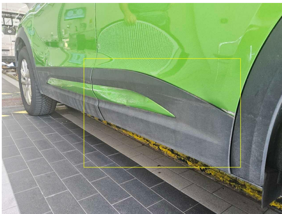
Bild 24 : Seitenschaden links, zerkratzt / deformiert (Tür hinten links)
