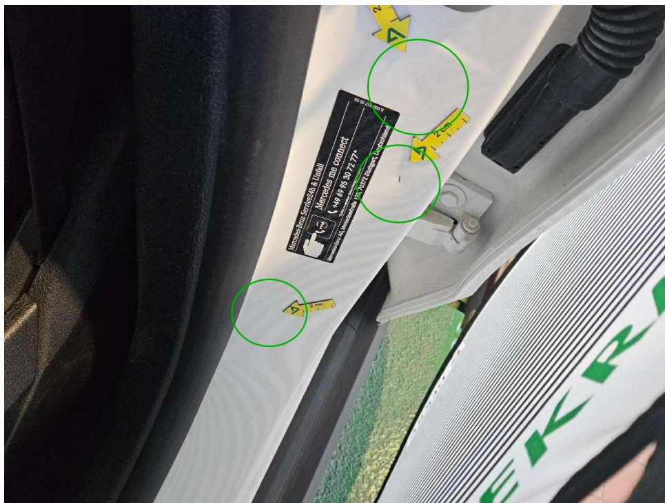
Bild 15 : Einstieg vorne links mehrfach eingedellt und verschrammt
