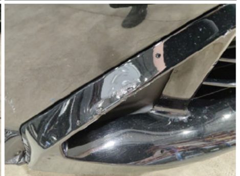
Stoßfängerleiste / Vorne / Delle
