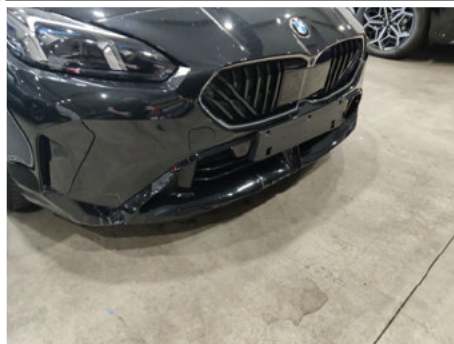
Stoßfängerleiste / Vorne / Delle
