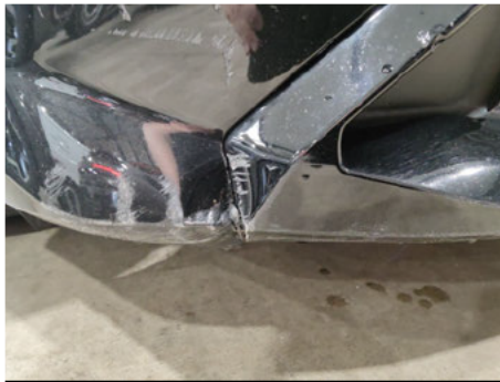
Stoßfängerleiste / Vorne / Delle
