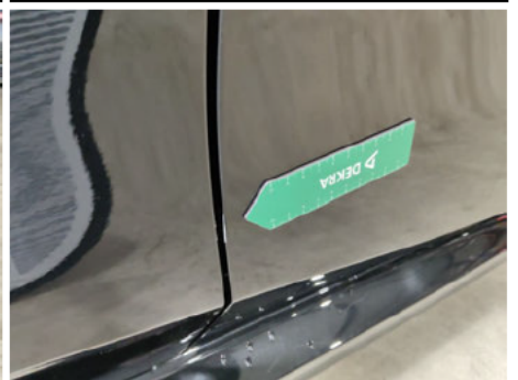
Tür / Vorne Rechts / Kratzer
