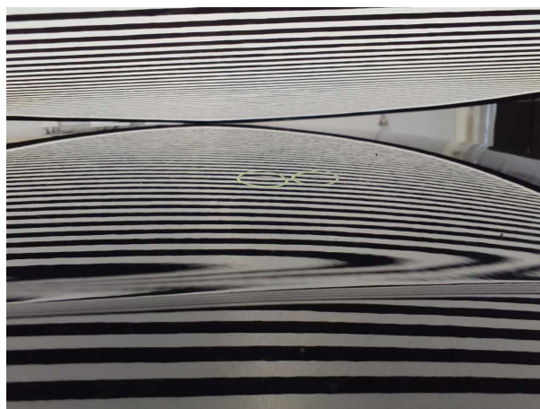
Beschädigung #2: Fahrzeugdach: Dach - Delle(n) - Smart Repair
