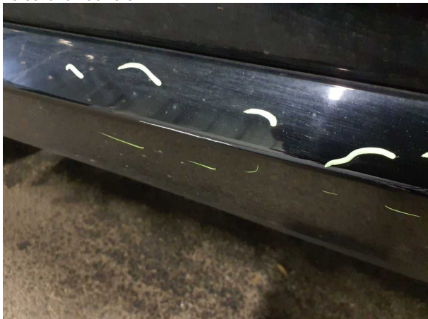
Beschädigung #8: Tür vorn links: Tür (inkl. Zierleiste) - verkratzt / verschürft - lackieren
