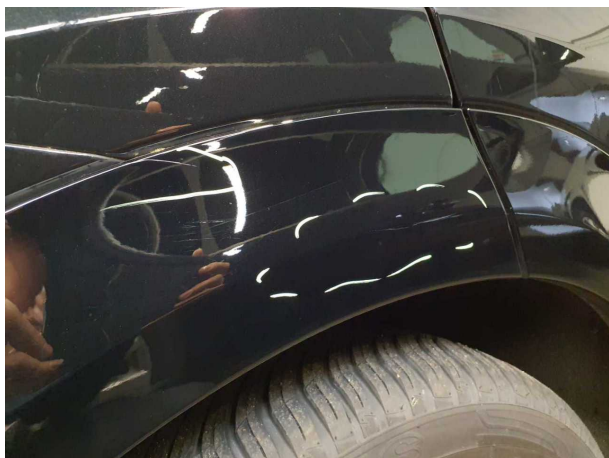
Beschädigung #4: Seitenwand rechts: Radhausverbreiterung - verkratzt / verschürft - erneuern
