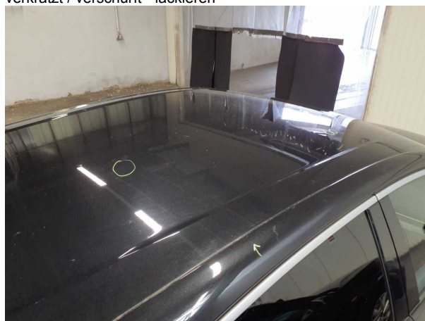
Beschädigung #2: Fahrzeugdach: Dach - Delle(n) - Smart Repair
