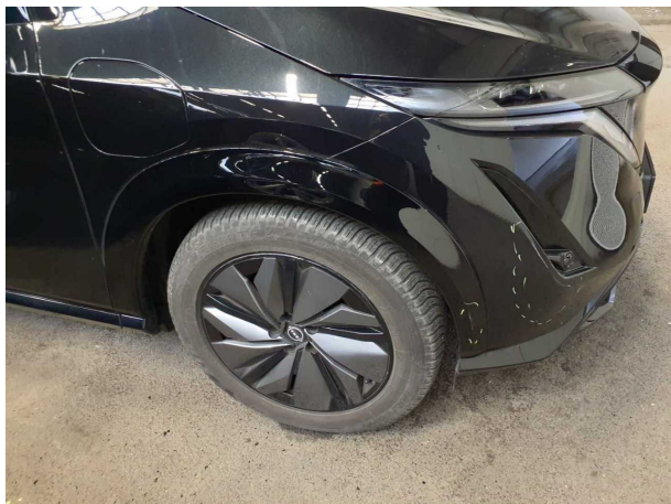
Beschädigung #1: Kotflügel rechts: Radhausverbreiterung - verkratzt / verschürft - lackieren
