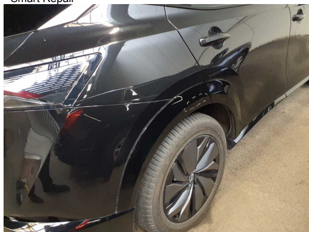
Beschädigung #4: Seitenwand rechts: Radhausverbreiterung - verkratzt / verschürft - erneuern
