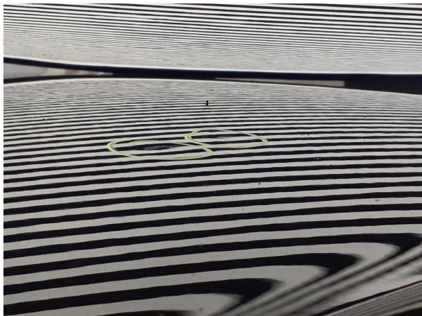
Beschädigung #2: Fahrzeugdach: Dach - Delle(n) - Smart Repair
