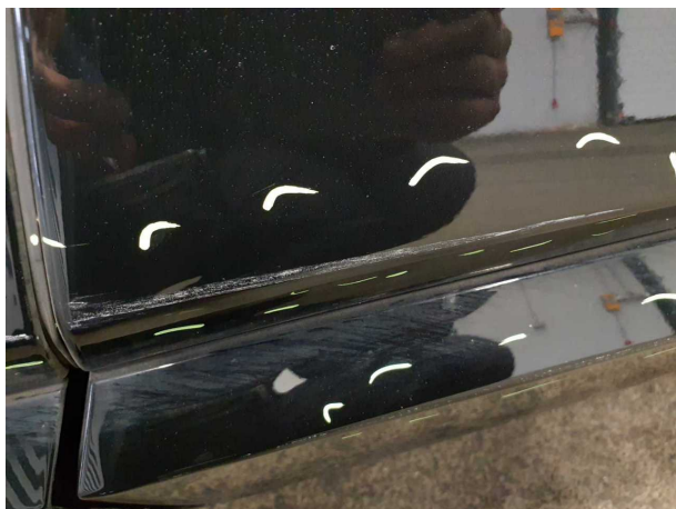
Beschädigung #6: Tür hinten links: Tür (inkl. Zierleiste) - verkratzt / verschürft - lackieren
