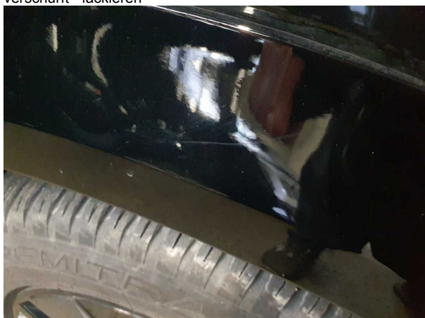
Beschädigung #1: Kotflügel rechts: Radhausverbreiterung - verkratzt / verschürft - lackieren
