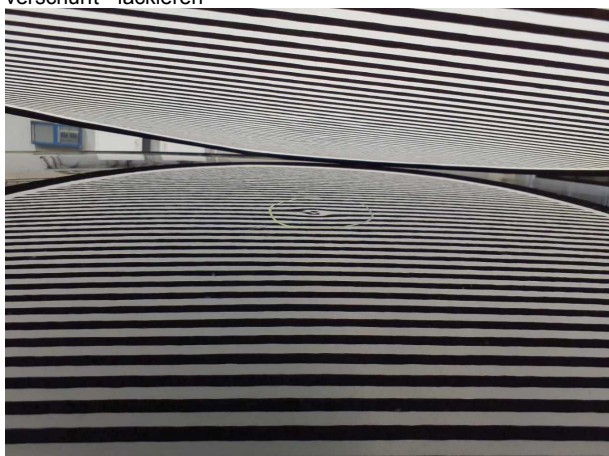
Beschädigung #2: Fahrzeugdach: Dach - Delle(n) - Smart Repair
