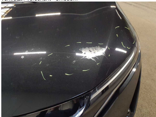
Beschädigung #5: Motorhaube: Motorhaube (Anhaftungen/ Schleifspuren) - Lackmangel - lackieren
