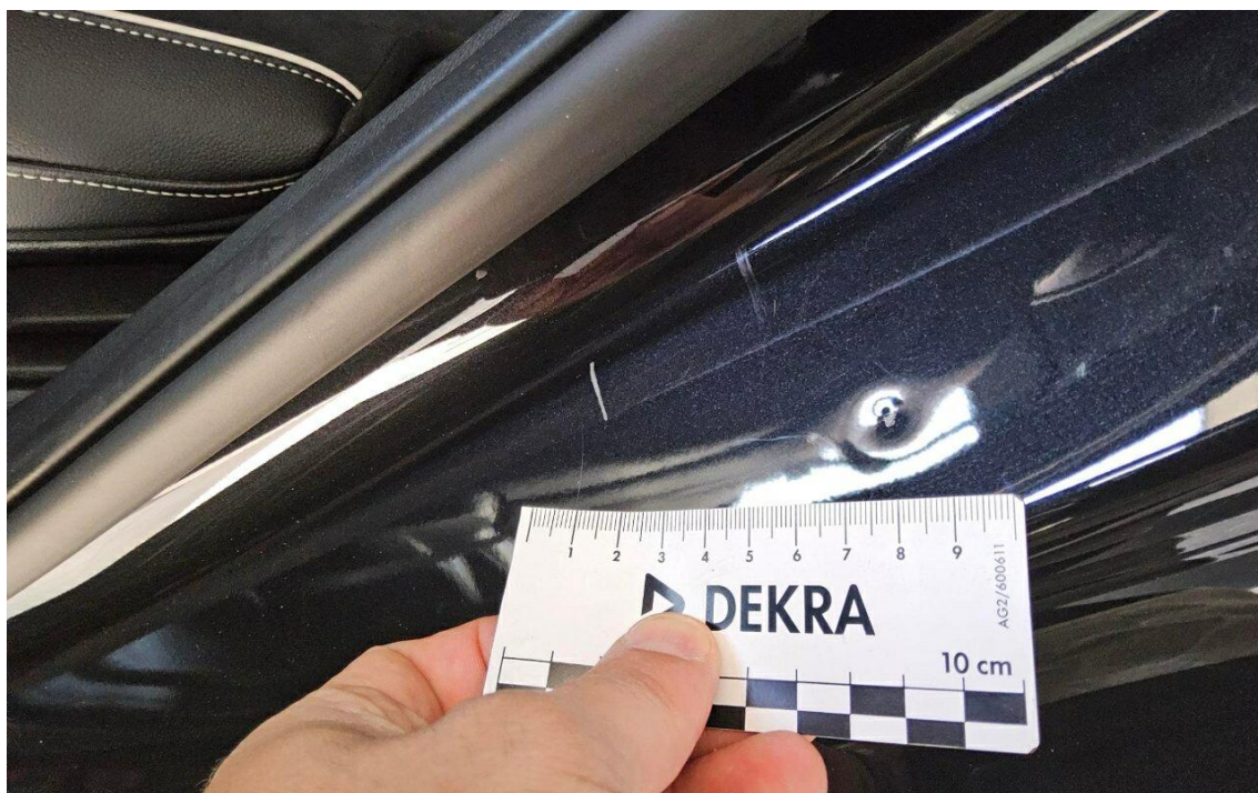
Bild 9 : Tür hinten links Einstieg, eingedellt, smart repair
