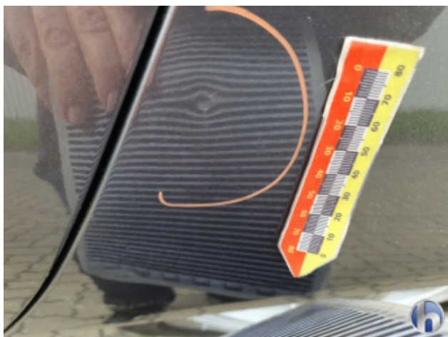
7. Seitenwand - Hinten - Links Gebrauchsspuren - Ohne Reparatur
