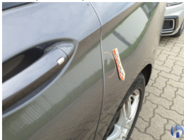
7. Seitenwand - Hinten - Links Gebrauchsspuren - Ohne Reparatur
