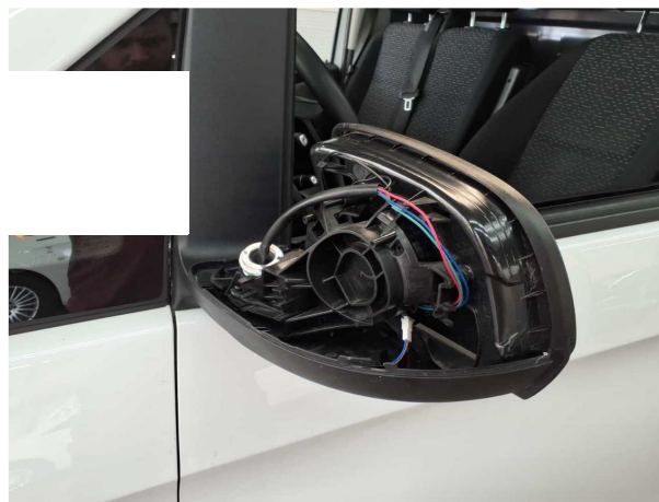
Beschädigung #2: Außenspiegel links: Abdeckkappe - fehlt - erneuern
