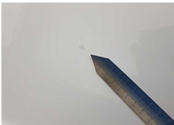
Beschädigung #8: Seitenwand links: Seitenwand - Delle(n) - Smart Repair
