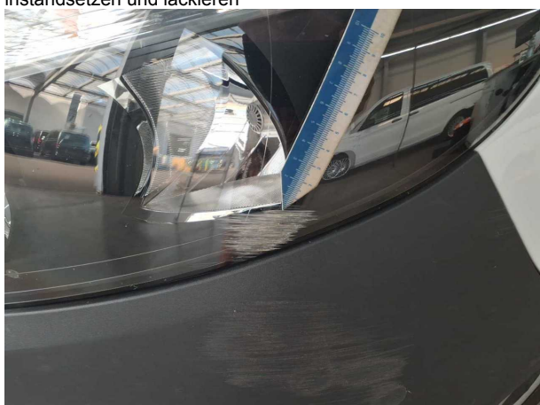
Beschädigung #10: Scheinwerfer: Scheinwerfer links - verkratzt / verschürft - erneuern
