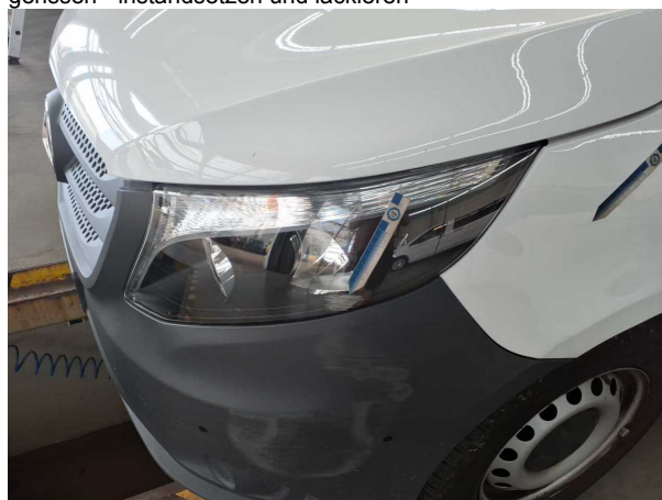
Beschädigung #10: Scheinwerfer: Scheinwerfer links - verkratzt / verschürft - erneuern
