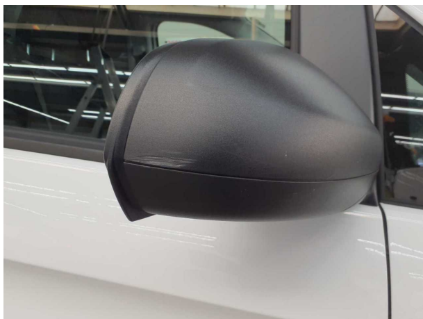
Beschädigung #1: Außenspiegel rechts: Abdeckkappe - verkratzt / verschürft - erneuern
