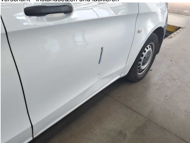
Beschädigung #17: Tür vorn rechts: Tür - verformt - erneuern
