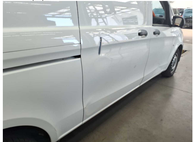
Beschädigung #15: Schiebetür rechts: Schiebetür - verformt - instandsetzen/lackieren (S2)
