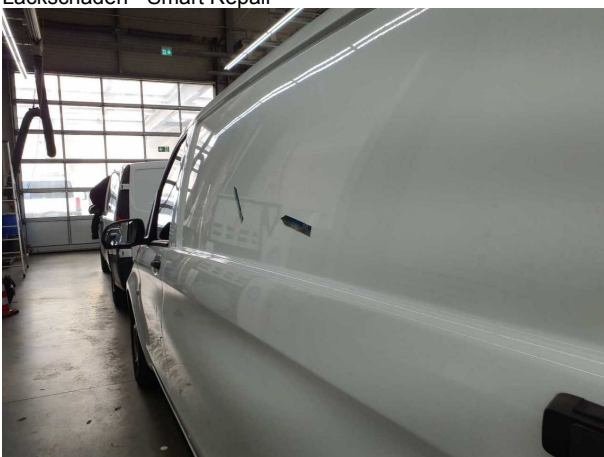
Beschädigung #8: Seitenwand links: Seitenwand - Delle(n) - Smart Repair
