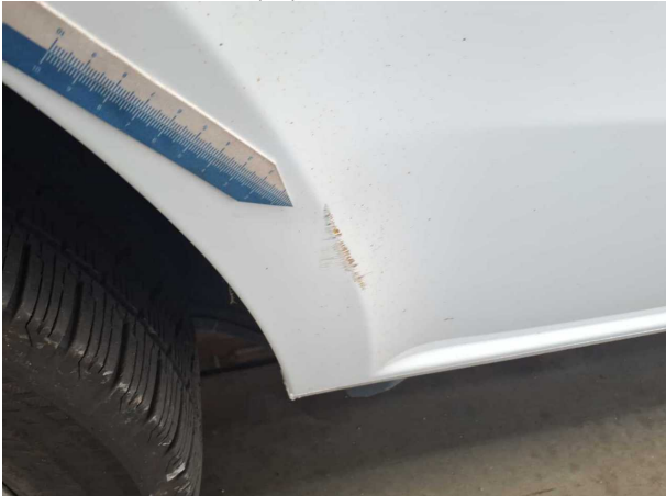
Beschädigung #16: Seitenwand rechts: Seitenwand - verkratzt / verschürft - instandsetzen und lackieren
