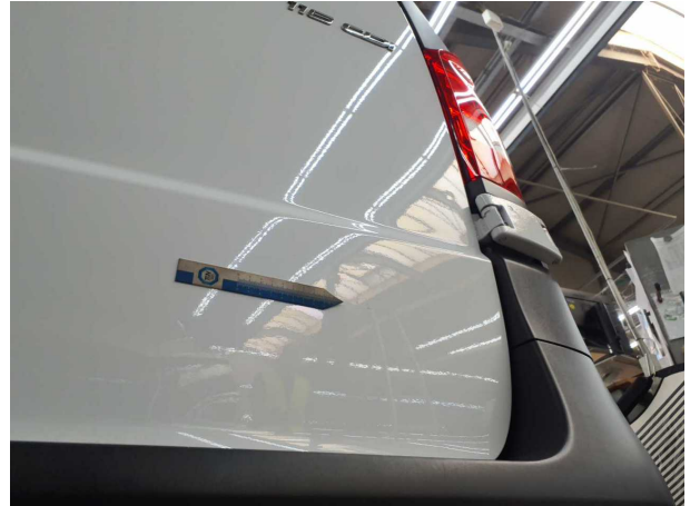
Beschädigung #6: Heckklappe/-tür: Hecktür rechts - Delle / Lackschaden - Smart Repair
