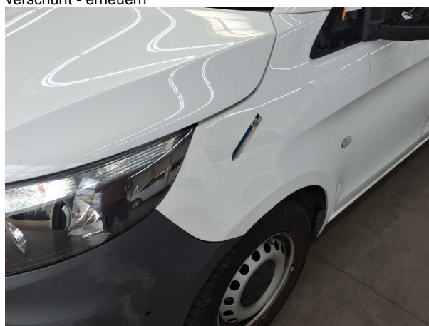
Beschädigung #11: Kotflügel links: Kotflügel links - verformt - erneuern
