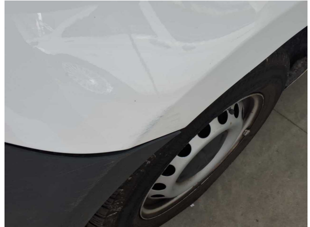
Beschädigung #11: Kotflügel links: Kotflügel links - verformt - erneuern
