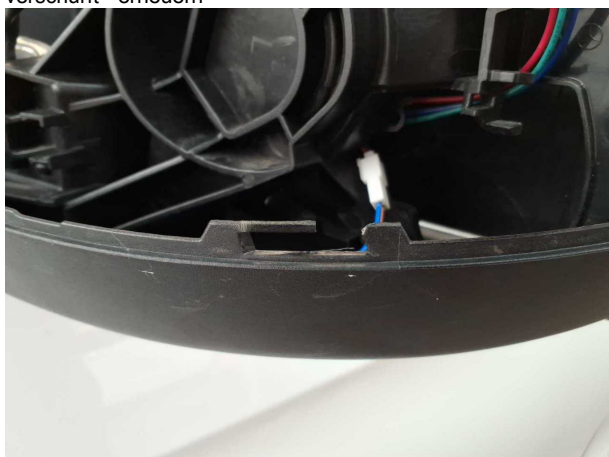
Beschädigung #3: Außenspiegel links: Spiegelgehäuse - gebrochen / gerissen - erneuern
