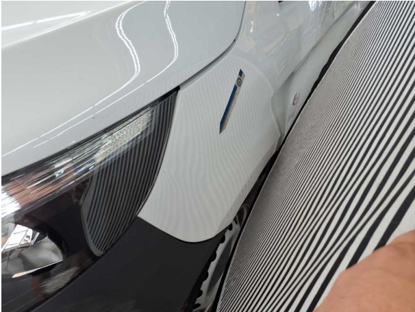
Beschädigung #11: Kotflügel links: Kotflügel links - verformt - erneuern
