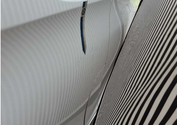
Beschädigung #14: Tür vorn links: Tür - verformt - instandsetzen/lackieren (S1)
