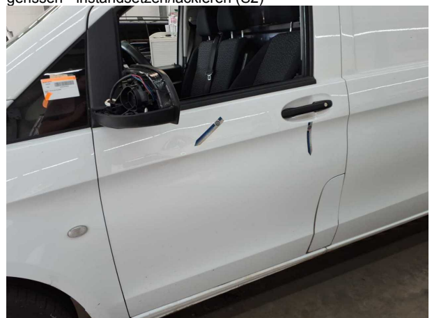
Beschädigung #14: Tür vorn links: Tür - verformt - instandsetzen/lackieren (S1)
