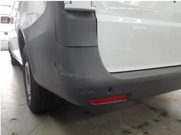
Beschädigung #12: Stossfänger hinten: Stossfänger mit Parktronic - beschädigt - erneuern
