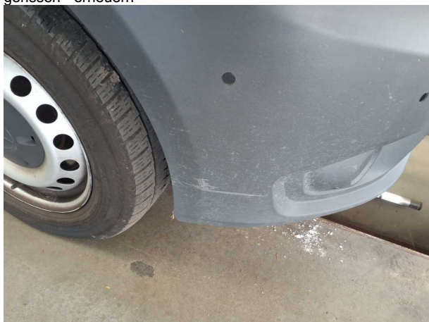
Beschädigung #4: Stossfänger vorn: Stossfänger mit Parktronic - verkratzt / verschürft - Smart Repair
