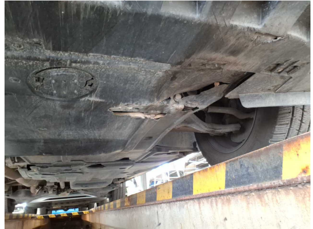
Beschädigung #7: Motor: Motorverkleidung unten - gebrochen / gerissen - erneuern
