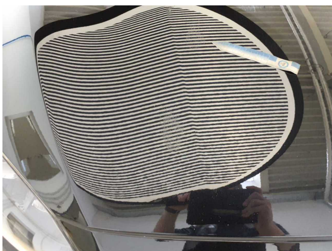
Damage 16: Bonnet: Bonnet (Anätzung) - Paint defect - Paint
