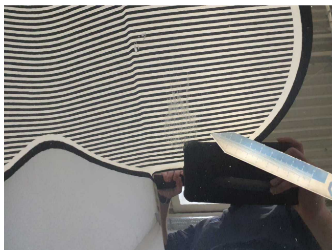
Damage 16: Bonnet: Bonnet (Anätzung) - Paint defect - Paint
