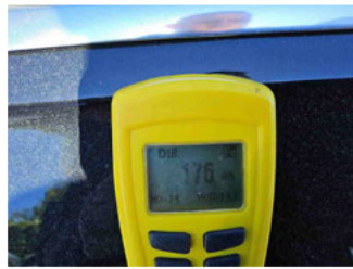
Lackstärke Seitenwand hinten rechts
