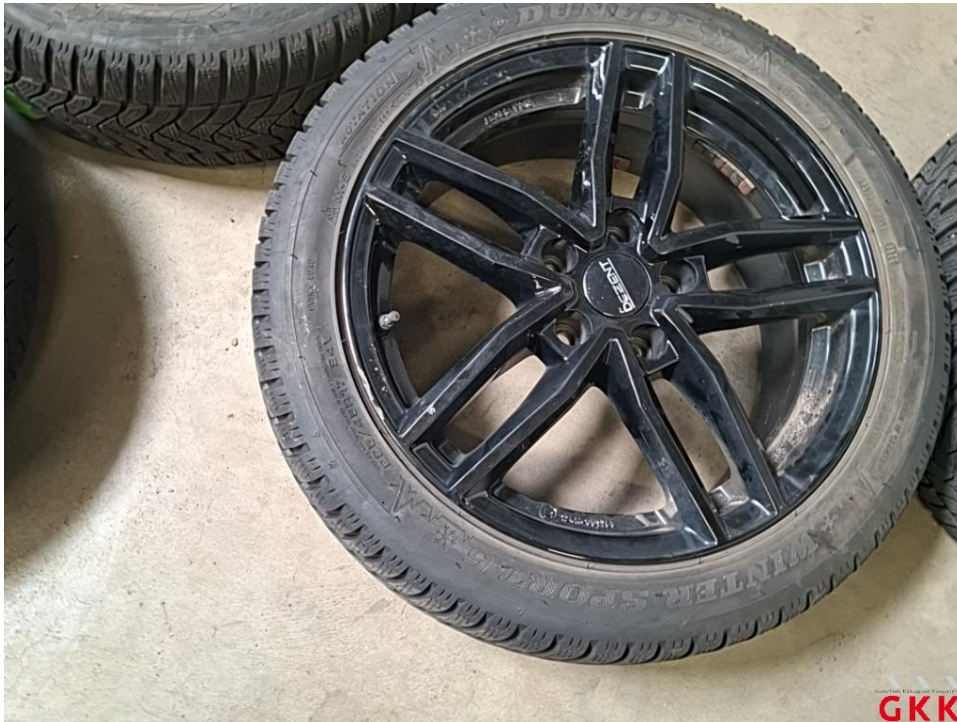
Bild 25 LM-Rad, 1 x beiliegend, Materialabtrag, ersetzen
