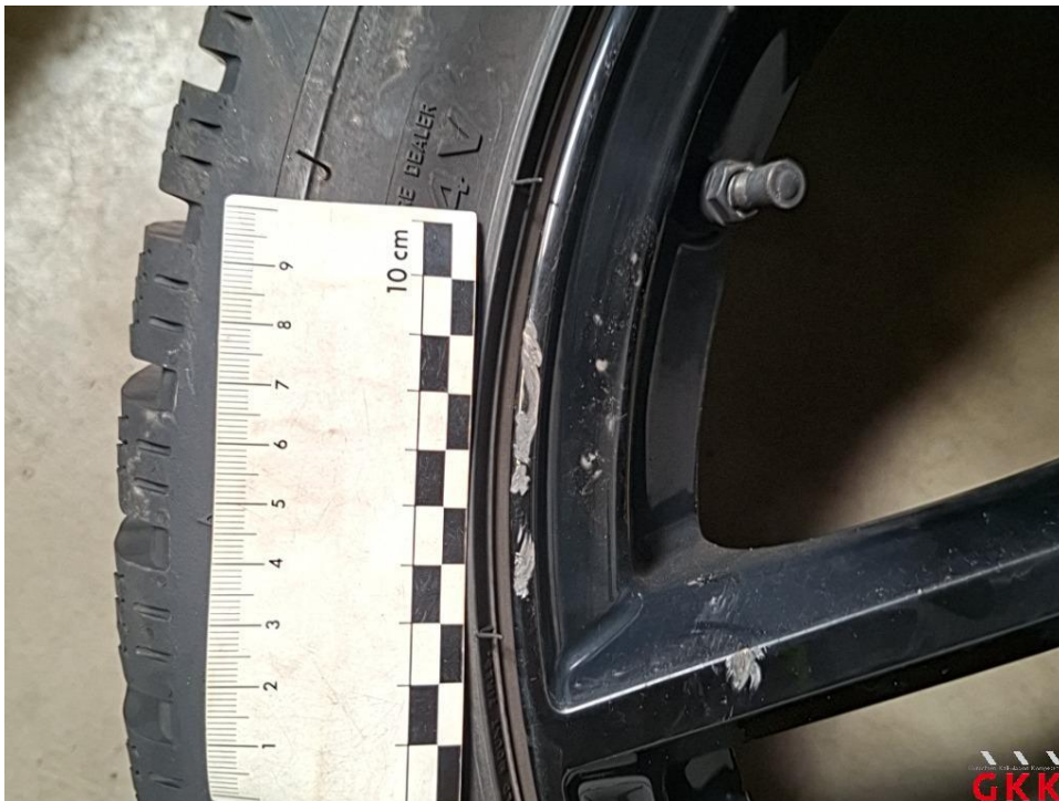
Bild 26 LM-Rad, 1 x beiliegend, Materialabtrag, ersetzen
