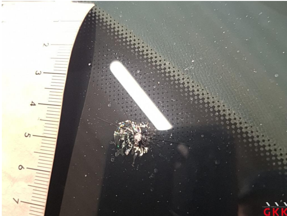
Bild 21 Frontscheibe, mit Regensensor und Frontkamera, Steinschlag mit Rissbildung, ersetzen
