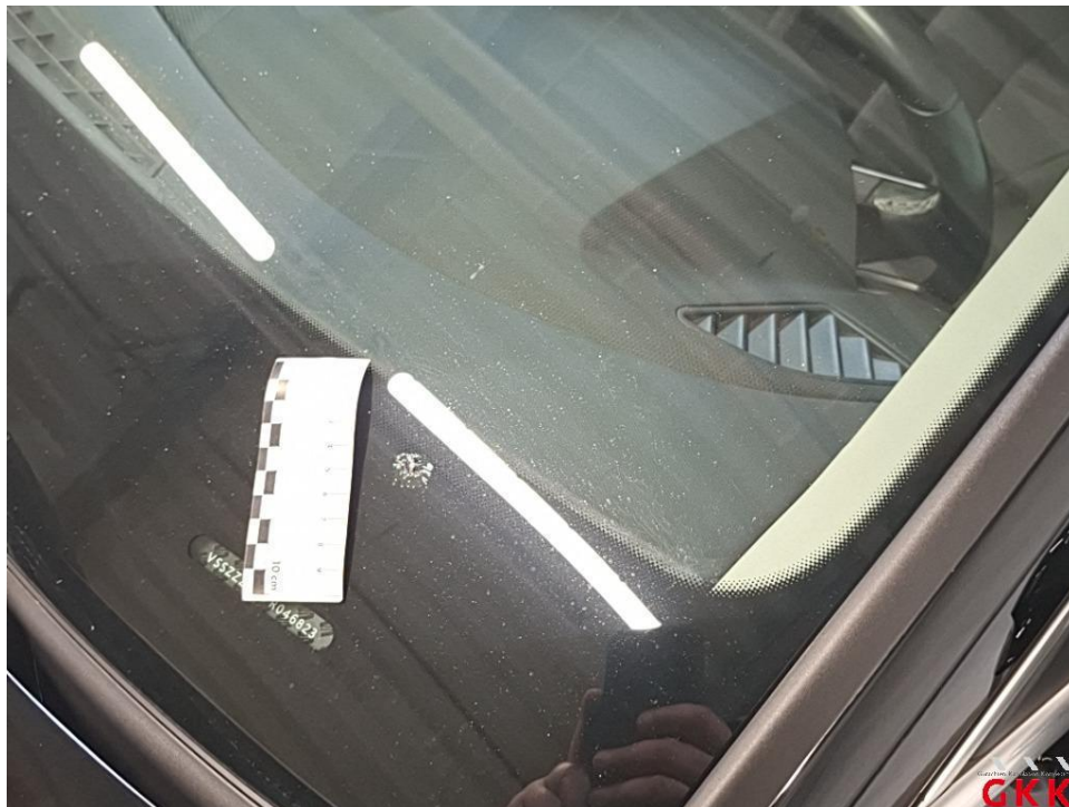
Bild 20 Frontscheibe, mit Regensensor und Frontkamera, Steinschlag mit Rissbildung, ersetzen
